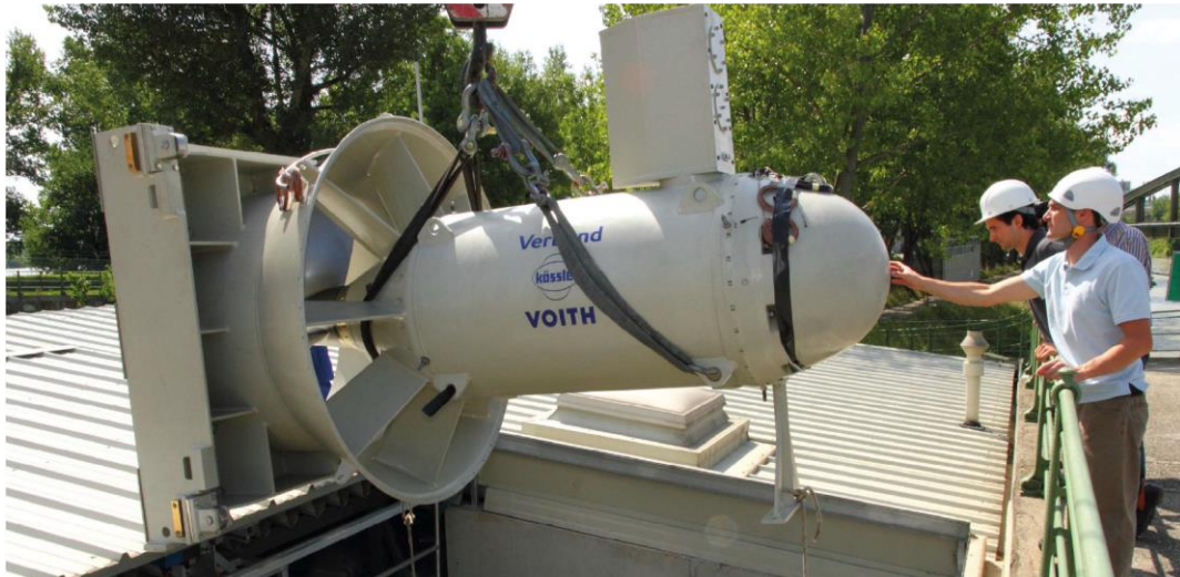
Figura 1: Unidade geradora compacta StreamDiver
