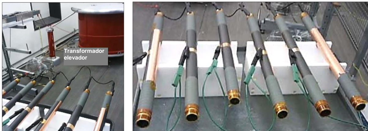
Fig. 3. Seis corpos de prova tubulares com OCP aterrado (preto) e com o sistema de atenuação (ECP cinza) foram submetidos a tensões elevadas em CA em um teste de envelhecimento acelerado em Temperatura Ambiente (RT)
