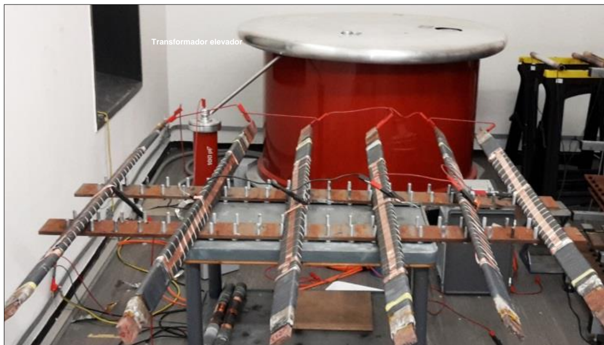
Fig. 7. Teste de envelhecimento elétrico acelerado em barras de enrolamentos estáticos com 1,6 m de comprimento e seção transversal original de um hidrogerador indiretamente resfriado a ar com U_n = 13,8 \text{ kV}
