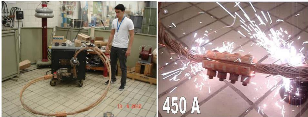
Figura 3 – Passagem de Corrente pela Conexão Defeituosa – faiscante
