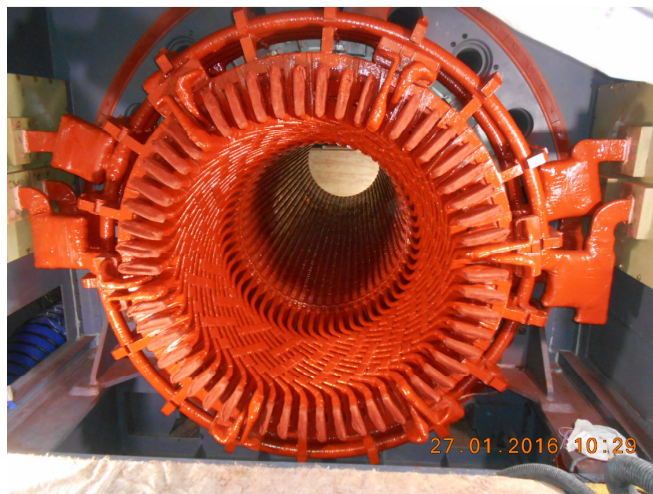
FIGURA 10 – Enrolamento estatórico do CT-02 após a rebobinagem.
