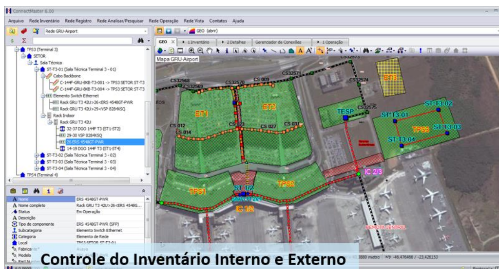
FIGURA 3 – Visão geral da rede em um aeroporto, sobreposta a uma imagem de satélite.
