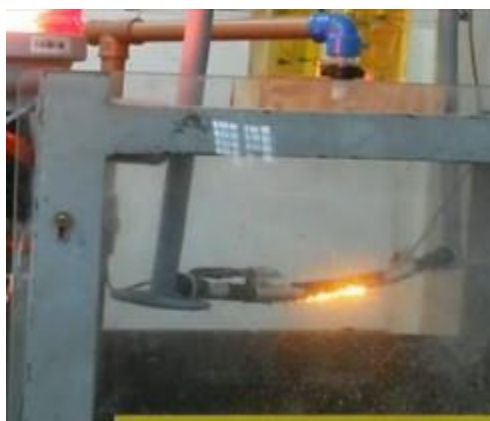
Figura 3 – Amostra em teste de trilhamento elétrico
