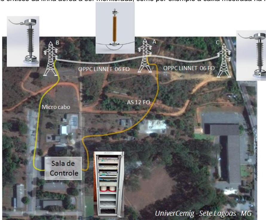
FIGURA 7 - Foto aérea mostrando a disposição da rede óptica e dos elementos instalados.
