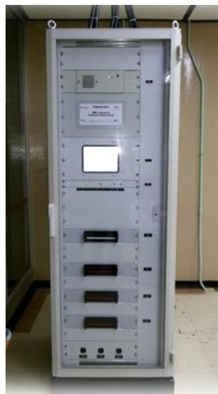
Figura 4 – Registrador de Perturbações e Medição Fasorial desenvolvido pela equipe de TA do PTI.
