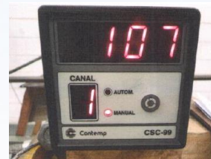
Foto 20 – Temperatura meio da emenda (canal 1)
