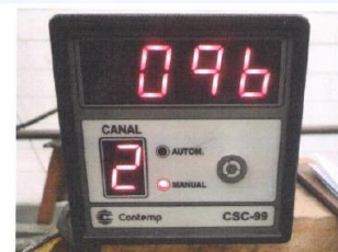
Foto 21 – Temperatura ¾" da emenda (canal 2)
