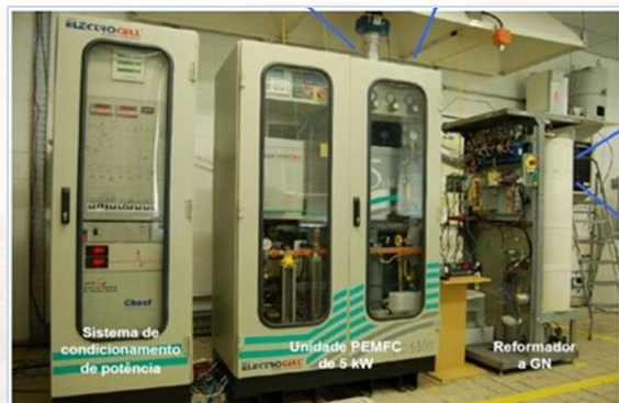
Sistema GD: PEMFC-5kWe + Reformador de GN.
