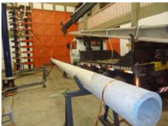
Figura 9 - Ensaio de impulso atmosférico em poste autoaterrado
