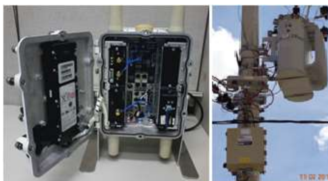
FIGURA 9 – Instalação em campo dos roteadores
