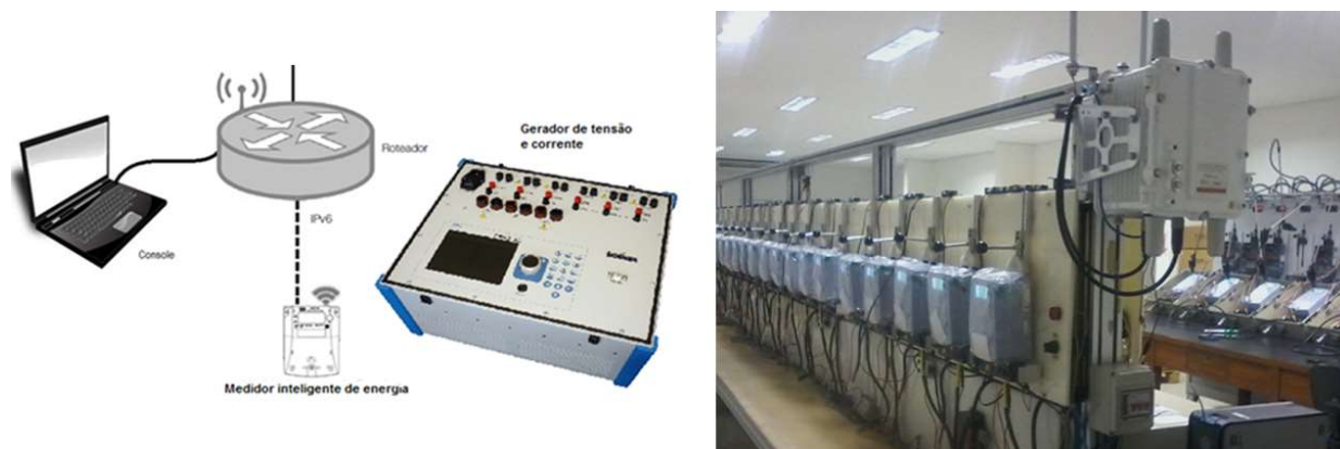
FIGURA 7 – Estrutura utilizada para os testes em laboratório
