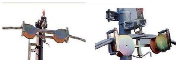
FIGURA 8 – Roldanas múltiplas por estruturas passantes (suspensão)
