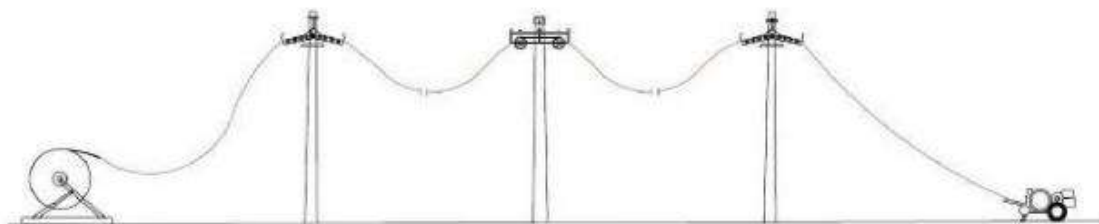
FIGURA 12 – Fase inicial: tração do cabo
