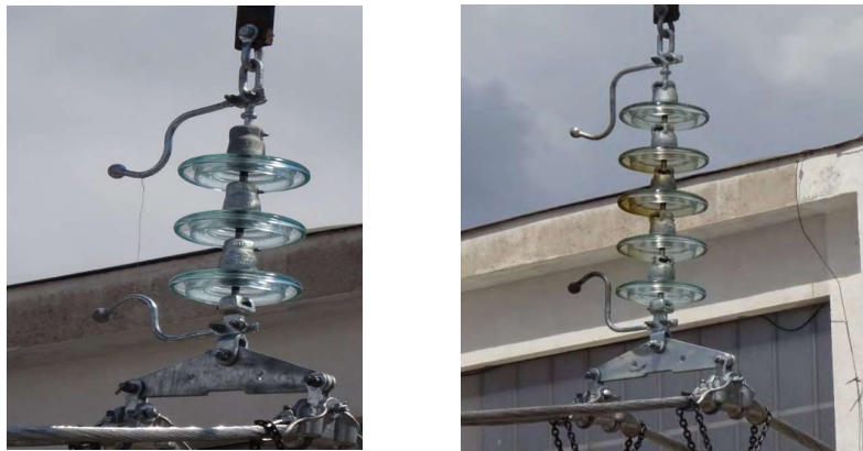
FIGURA 10 - Cadeia de Isoladores ensaiadas com 3 e 5 isoladores, indicando o centelhador tipo chifre vertical
