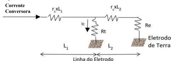
FIGURA 6 - Circuito para Cálculo da Corrente de Arco
