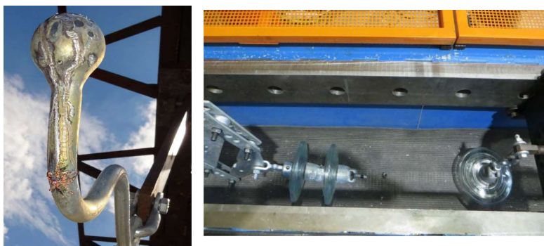
FIGURA 12 - Efeito do arco no centelhador e ensaio mecânico destrutivo a cadeia, comprovando o atendimento aos requisitos de integridade.
