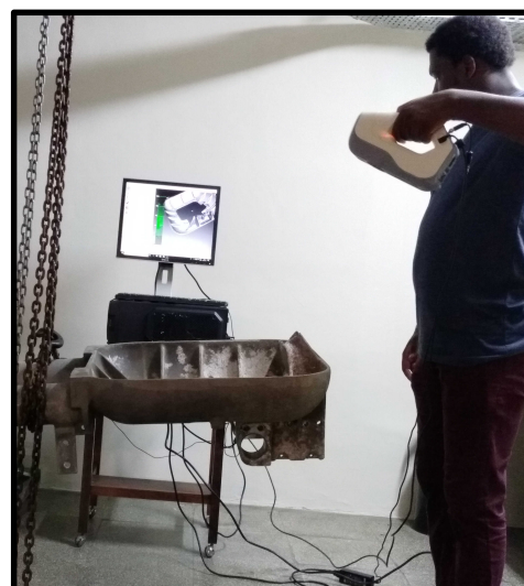
FIGURA 5 – Peças sendo escaneadas para modelagem (plataforma de escaneamento Artec).
