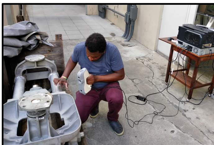
FIGURA 5 – Peças sendo escaneadas para modelagem (plataforma de escaneamento Artec).
