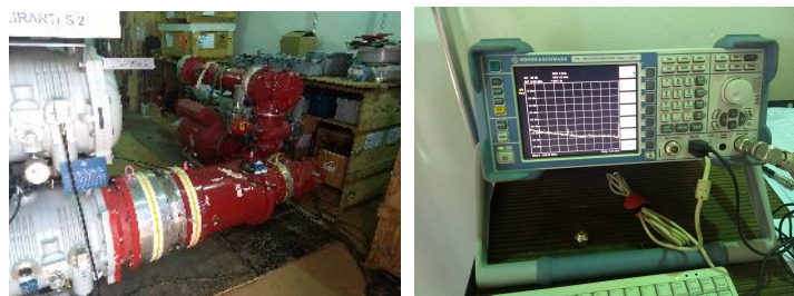
FIGURA 8 – Gerador de tensão para o ensaio e a medição de descarga parcial.
