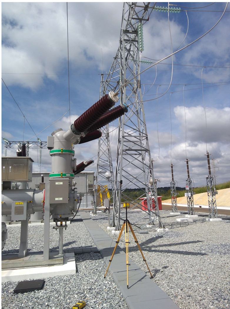
Figura 8 – Medição de campo elétrico internamente ao pátio de SE híbrida de 138 kV.
