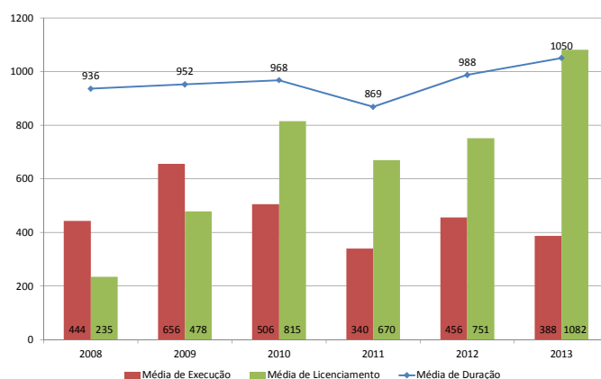
FIGURA 1 – Tempo médio anual, em dias, das obras analisadas: tempo total, execução física das obras e licenciamento ambiental.
