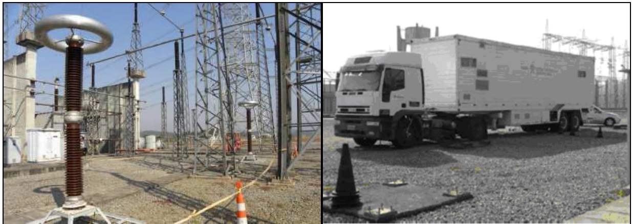
Figura 1 – Sistema de medição do CTE.O – DCP's e Laboratório Móvel para a aquisição das medições
