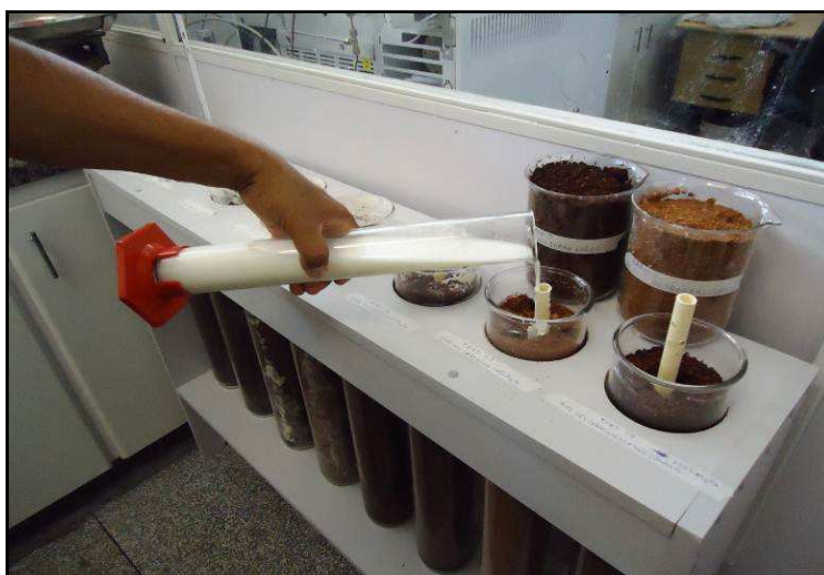
Figura 3 – Solução de peróxido de magnésio na concentração de 5%, sendo acrescida à massa dos resíduos na coluna 07.
