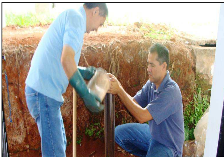
Figura 2 – Preenchimento das colunas com resíduo oleoso em diferentes proporções na mistura com húmus e composto orgânico.
