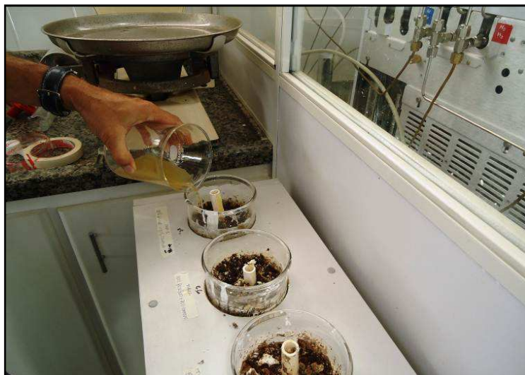
Figura 4 – Coloração mais clara do efluente de água e óleo gerado a partir dos resíduos da coluna 01.
