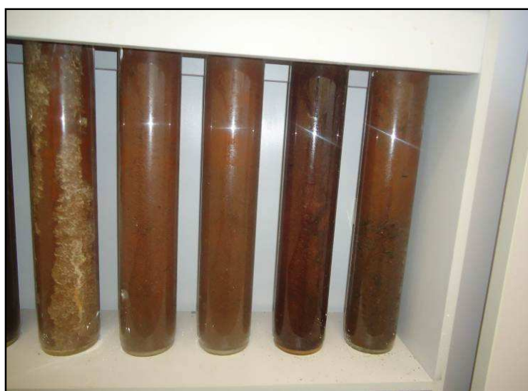
Figura 5 – Formação de canais nas colunas de vidro, devido a liberação de oxigênio, com início de formação de fungos.
