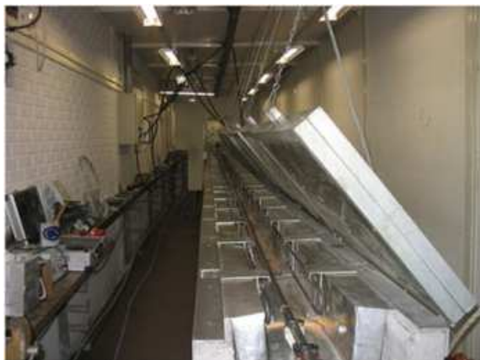
Figura 2. Bancada 1 de ensaios em cabos – sistema de aquecimento de cabos condutores por corrente em vão confinado.
