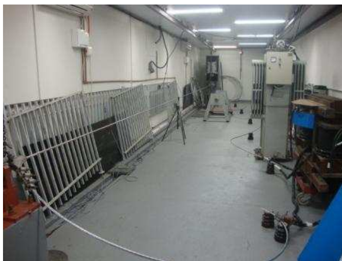
Figura 4 – Bancada 3 mostrando o vão de até 13 m e 0,9 m de altura – bancada utiliza nos ensaios.
