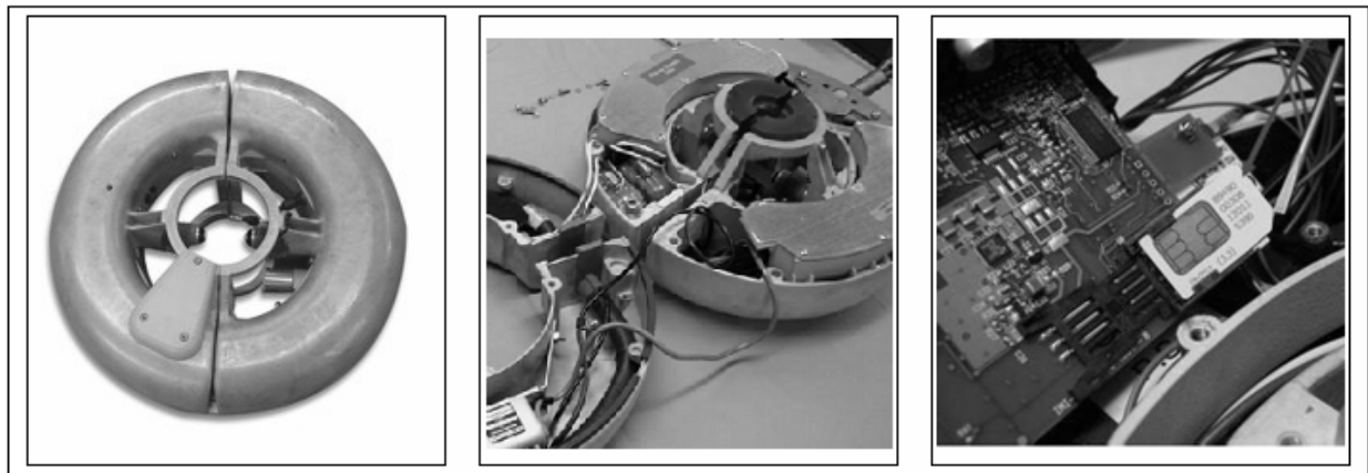
FIGURA 2 - Abertura do Donut-2 para inserção do chip de comunicação GSM/GPRS/EDGE
