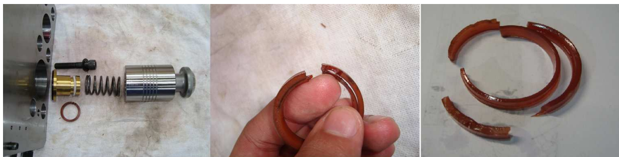
Figura 4 – Retentor da válvula de abertura danificado
