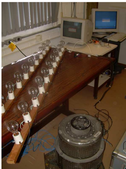
Figura 2 – Aparato experimental dos ensaios de validação da metodologia.
