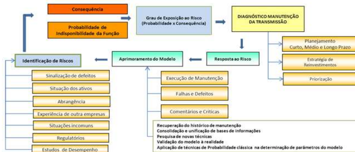
FIGURA 1 – Macro fluxo do diagnóstico com a abordagem de riscos, entradas e saídas.
