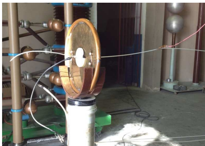
FIGURA 5 – VISTA DO ENSAIO EM LINHA DE MÃO ISOLANTE LIMPA
