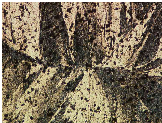
Figura 7 – Fotomicrografia da microestrutura apresentada pelos cabos usados.
