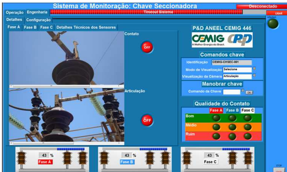
FIGURA 7 - Uma das telas do software de controle do sistema de sensoriamentode chave seccionadoras.
