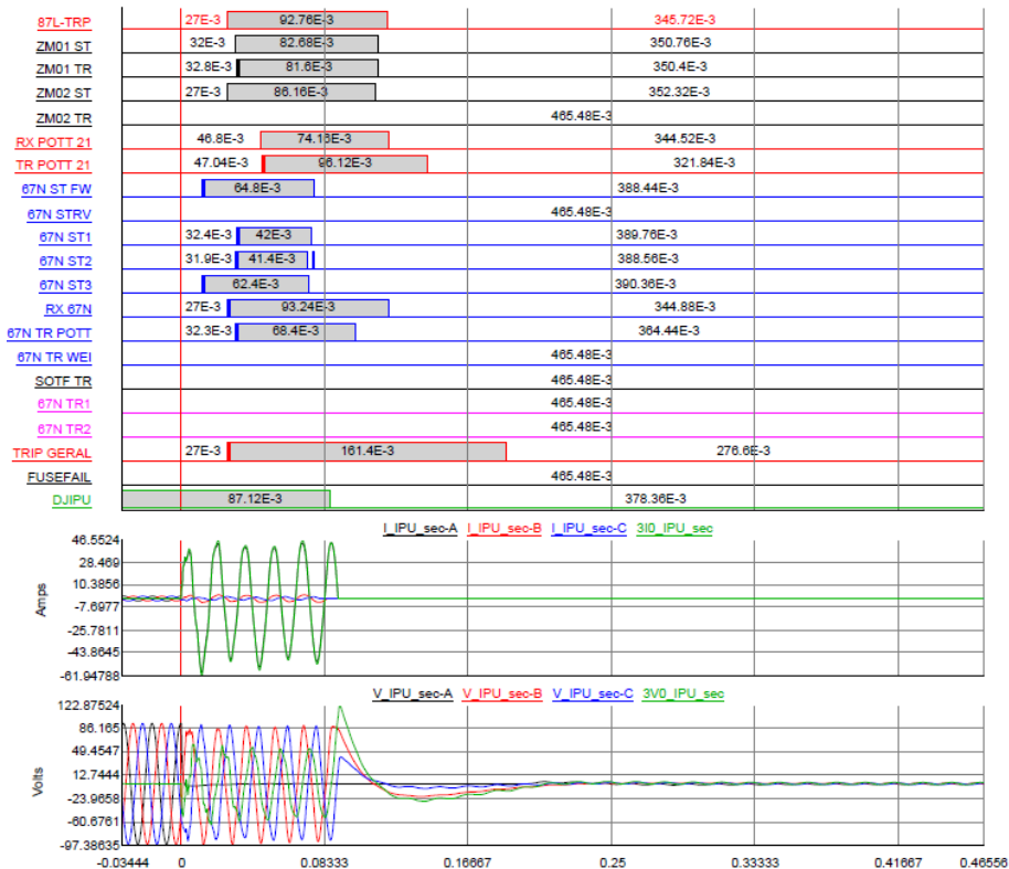
FIGURA 4 – Resultado de ensaio de falta 1Φ interna à linha protegida aplicada na proteção do terminal da ST-FI
