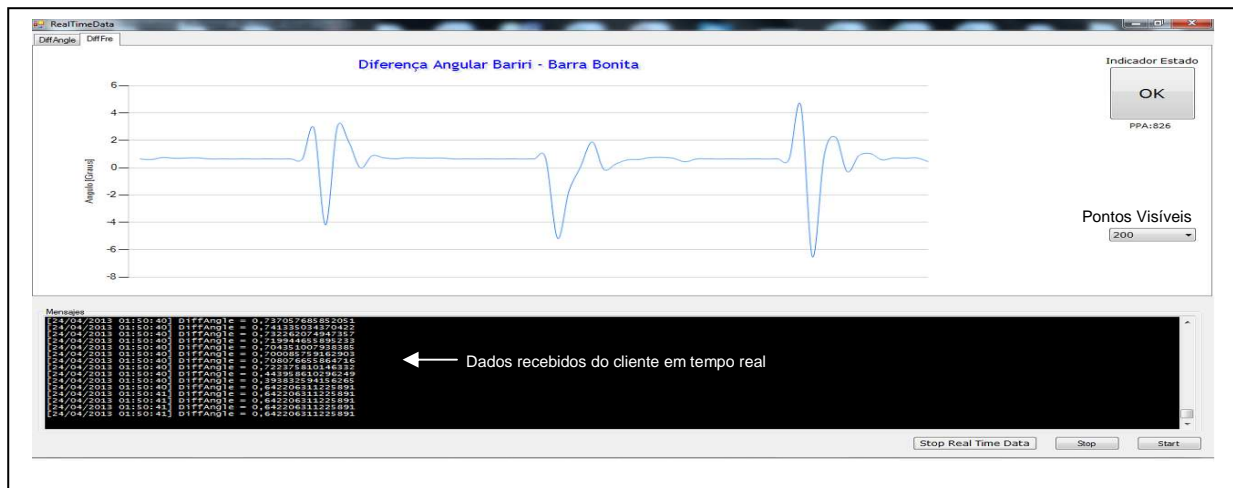
Fig.22 Diferença Angular, plotado em tempo real após a conexão entre o cliente e o servidor
