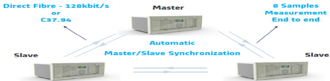
Figura 3 – Esquema de comunicação diferencial
