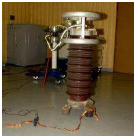
FIGURA 2 - Circuito de ensaio para avaliar a sensibilidade dos HFCT
