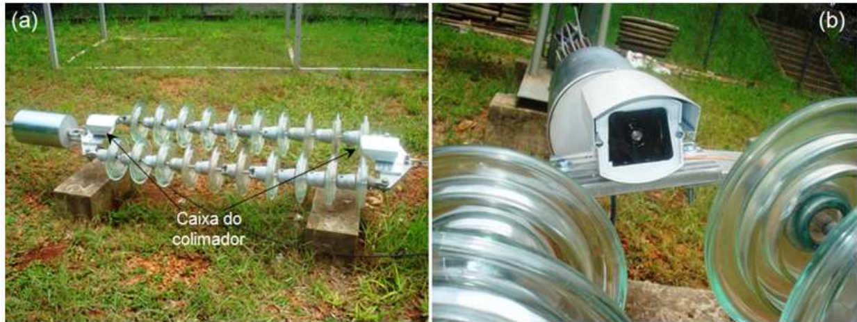
FIGURA 7 - (a) Emulação de linha de tensão aérea para teste do sistema FSO/DBG. A cadeia de isoladores é submetida à tração de 12000 N e (b) detalhe do encapsulamento do colimador.
