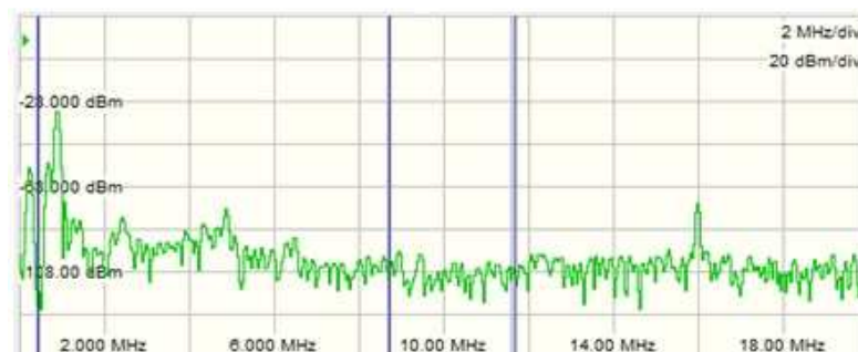
FIGURA 4 - Exemplo de representação FFT para classificação dos pulsos de descargas parciais com a determinação de três filtros de passagem de banda.
