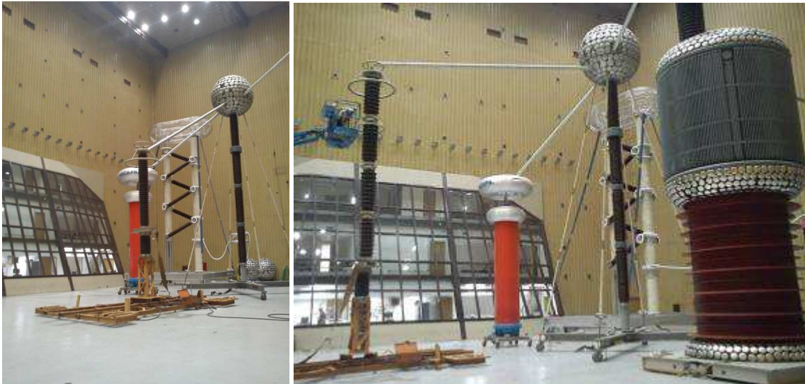
FIGURA 6 - Arranjo laboratorial de medição do pára-raios.
