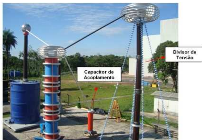
FIGURA 5 – Circuito de ensaio de para buchas de 550 kV.
