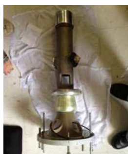
Fig. 12. Contato fixo interno do seccionador
