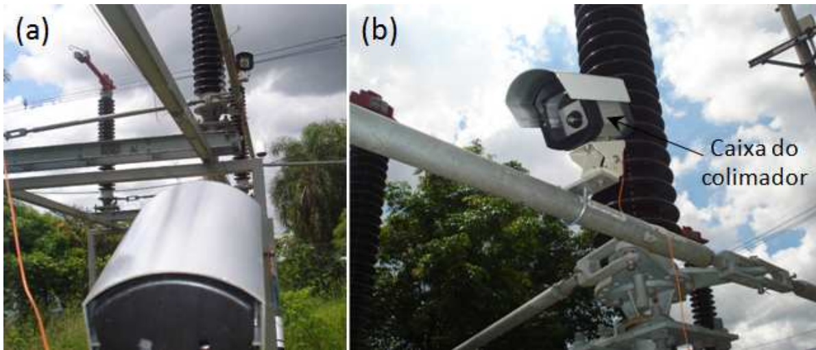
FIGURA 5 – (a) Sistema de monitoração FSO/FBG emulado para medição de temperatura em barramento de subestação e (b) detalhe dos dispositivos colimadores e seu empacotamento.
