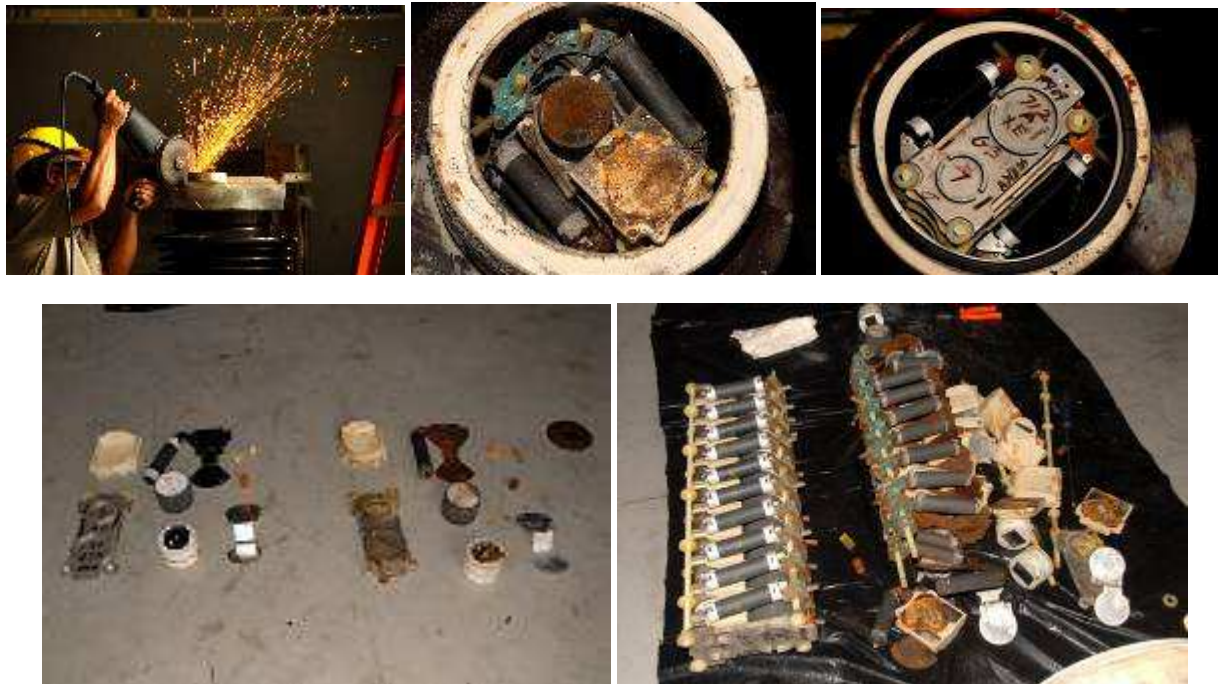
FIGURA 10 – Detalhes envolvendo a Abertura de dois módulos do PR de 500kV e o estado interno dos mesmos
