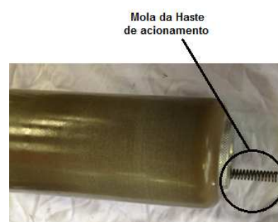
Fig. 13. Detalhe da mola do isolador da haste de acionamento
