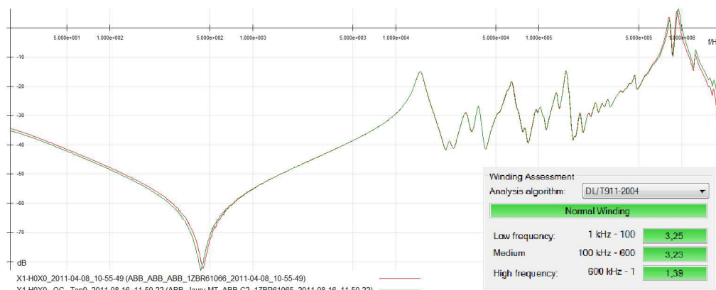
Figura 6 -Análise do ensaio de nº 2 (X1-H0X0- OC)- unidades irmãs - Fábrica 1ZBR61066- Fase "B" (vermelho) e Campo 1ZBR61065- Fase "A" (Verde)
