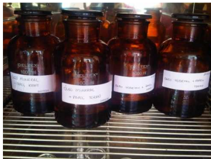
FIGURA 1 - Ensaios de envelhecimento acelerado em laboratório a 100 °C por um período de seis meses.
