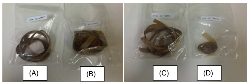
FIGURA 2 - Amostras de papel envelhecido, após a remoção do óleo residual por meio de extração: papel kraft neutro envelhecido em (A) OMI e (B) Biovolt A®; papel kraft termoestabilizado envelhecido em (C) OMI e em (D) Biovolt A®.
