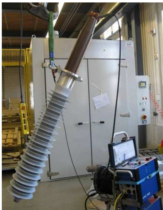
Figura 9: Ensaio de fator de perda de uma bucha de 123 kV RIS óleo-ar do lado de fora da câmara climática (visível na parte de trás).
