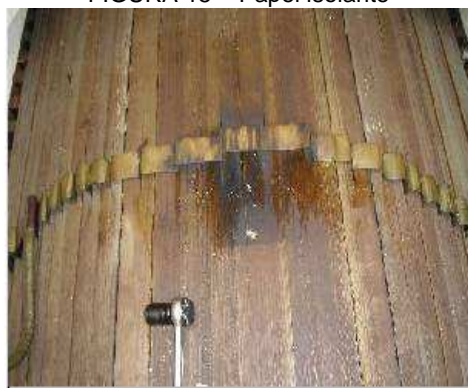
FIGURA 17 – Degradação do verniz isolante das chapas de silício
