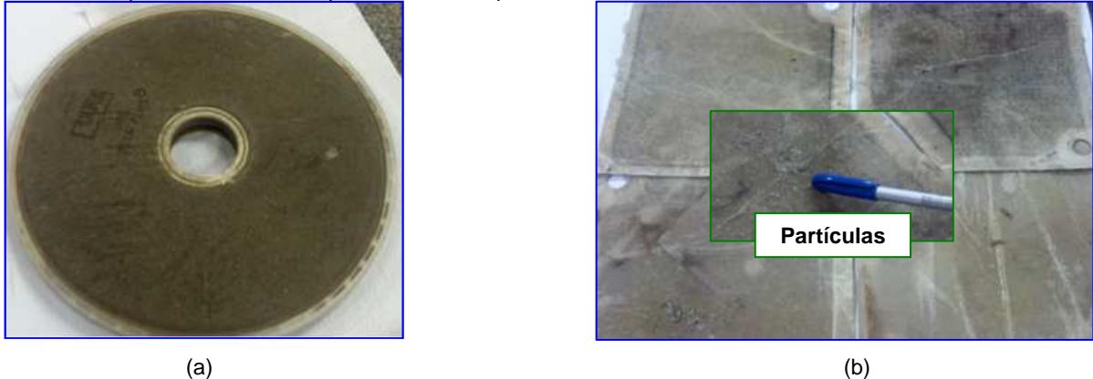
FIGURA 2 – Filtragem e tratamento: (a) filtro da máquina de tratamento do óleo; e (b) filtros do filtro-prensa.
