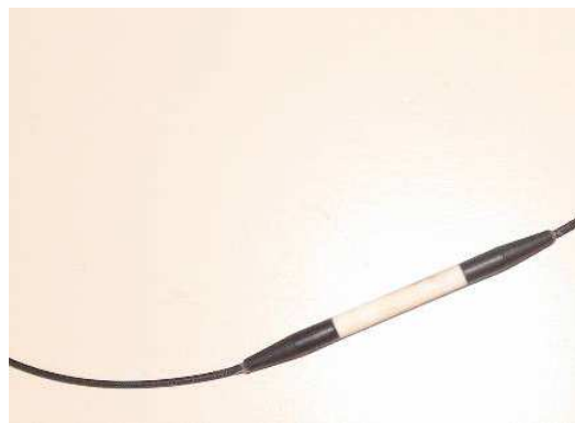
FIGURA 3. Detalhe do sensor de Bragg encapsulado
