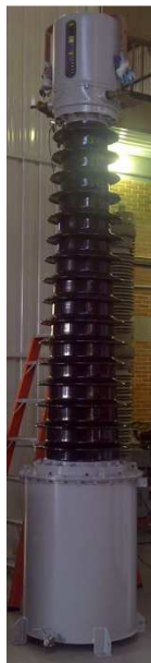
FIGURA 3 – Transformador de corrente em teste.
