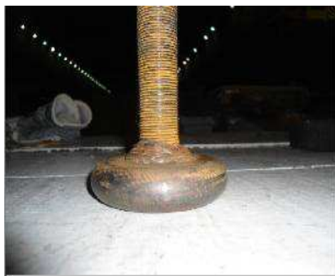
FIGURA 16 – Parafusos de fixação de apoio do núcleo oxidados
