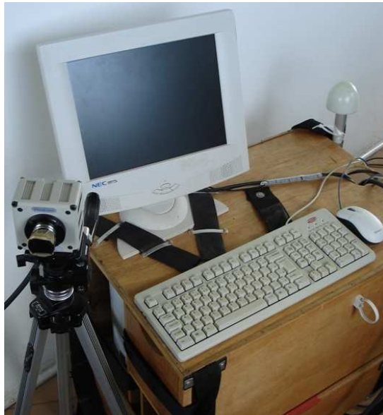
FIGURA 2 – Câmera rápida utilizada para o registro da corrente de longa duração.
