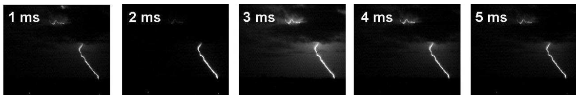
FIGURA 5 – Observação da corrente de longa duração em um registro da câmera rápida.
