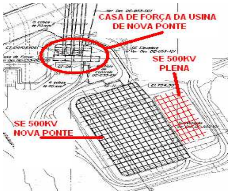
FIGURA 4 – ESQUEMA DA MALHA DE ATERRAMENTO
