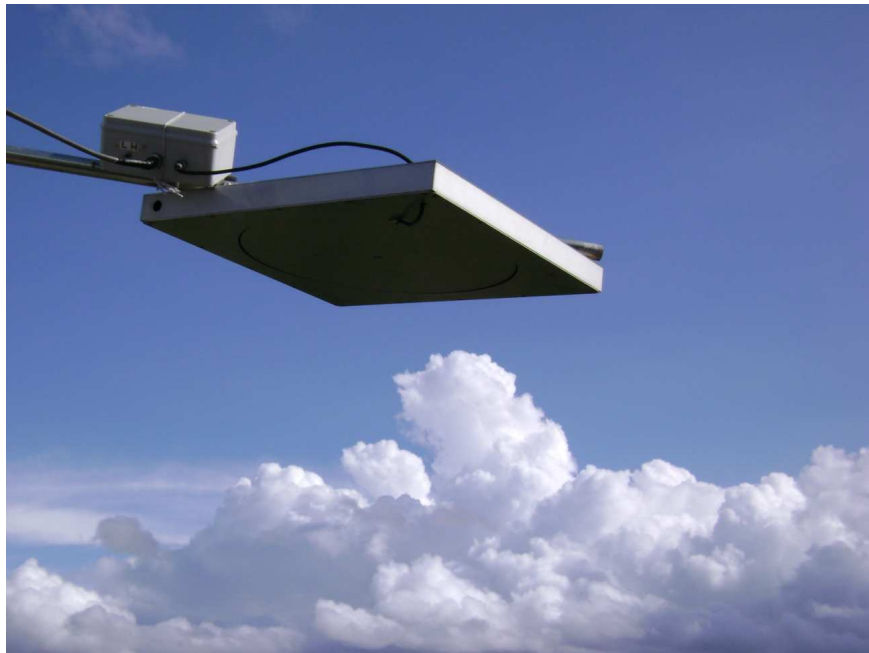
FIGURA 3 – Sensor de campo elétrico utilizado para o registro da corrente de longa duração.
