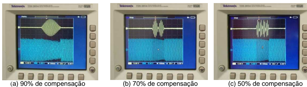
Figura 5 - Tensões entre os contatos do disjuntor utilizando o controlador para o religamento.
