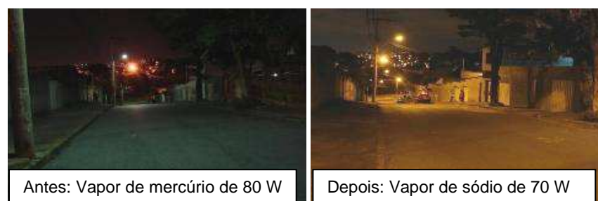
Figura 3 - Iluminação pública de Belo Horizonte antes e depois da substituição da IP
