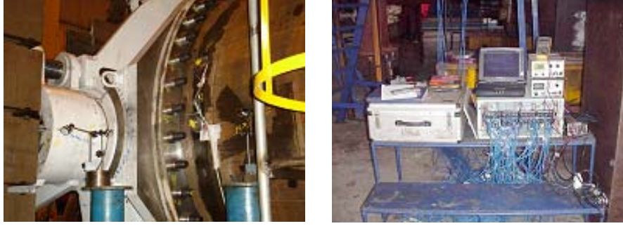
Figura 6 – Posicionamento dos extensômetros e relógios comparadores
