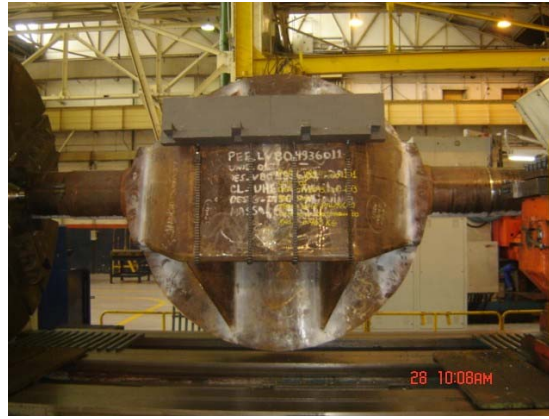
Figura 3 – Disco em processo de fabricação
