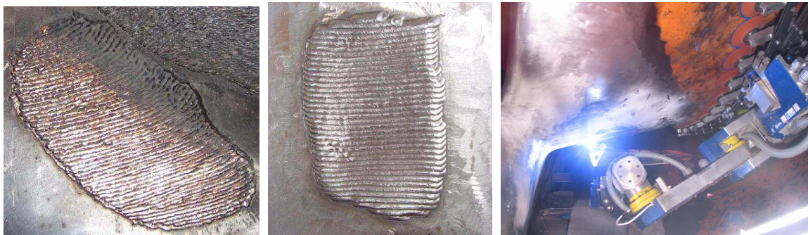
FIGURA 8 – Soldagens manual e robotizada. À direita, robô executando solda in loco.
