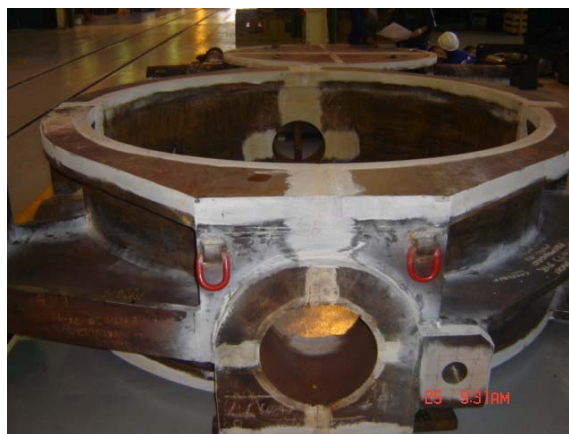
Figura 2 – Corpo da válvula borboleta em duas etapas do processo de fabricação.
