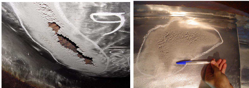
FIGURA 1 – Dois exemplos de zonas erodidas por cavitação em turbinas Francis
