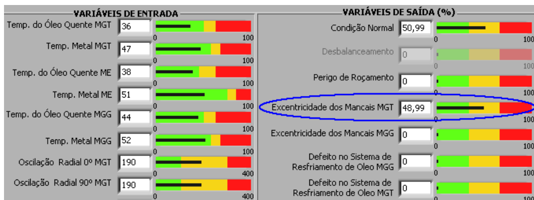
FIGURA 6 – Tendência de defeito de excentricidade na turbina
