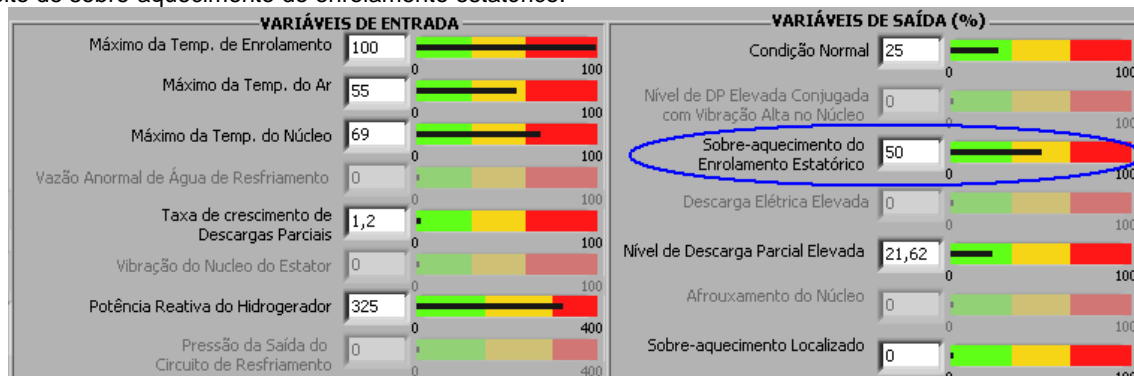
FIGURA 8 – Tendência de defeito de sobre-aquecimento do enrolamento estático
