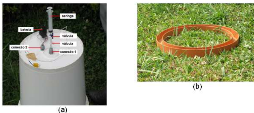
FIGURA 2 – (a) Câmara de fluxo com as conexões e (b) base metálica para fixação da câmara ao solo.
