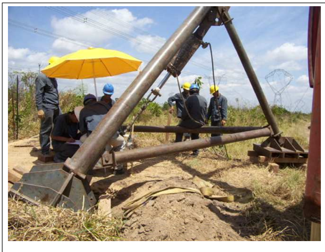
FIGURA 1 – Ensaio de Fundação
