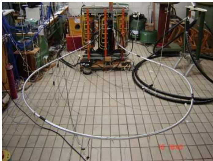
FIGURA 2. Arranjo experimental para monitoramento do comportamento térmico de cabos.
