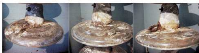
FIGURA 2 - Isoladores poluídos com dejetos de curicaca
