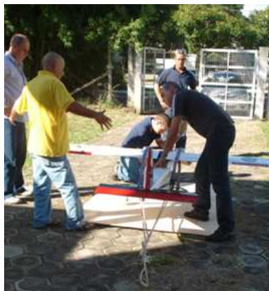
Figura 3 - Aeronave Alfa sendo prepara para ensaio de tração estática
