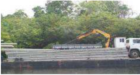
FIGURA 2- (a) – Balsa transportando postes de concreto
