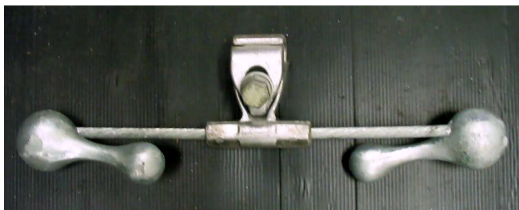
Figura 2 – Amortecedor tipo dogbone ensaiado
