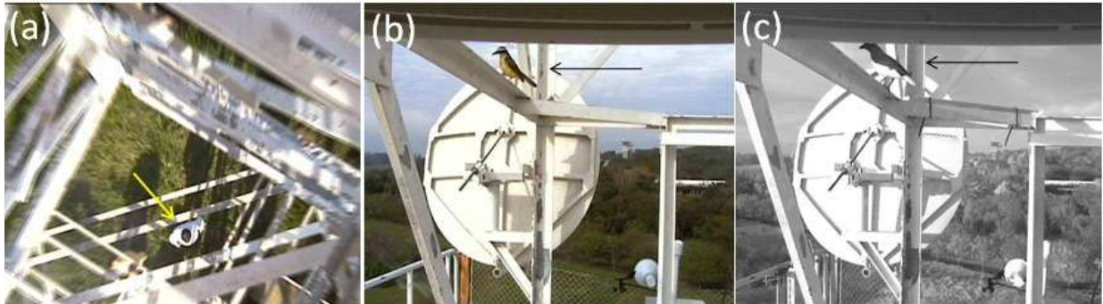
FIGURA 3 – Fotos tiradas pela câmera de vídeo do terminal 2 do TSR no CPqD, mostrando (a) pessoa detectada na base da torre, (b) pássaro detectado e afugentado de dia e (c) pássaro detectado e afugentado à noite.
