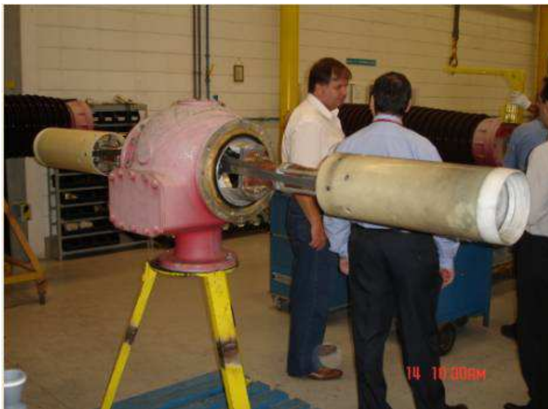
Figura 9 – Desmontagem das Câmaras do Pólo (B) na Fábrica
