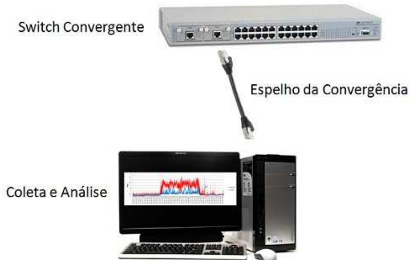
FIGURA 2 – Infraestrutura básica da solução de monitoramento
