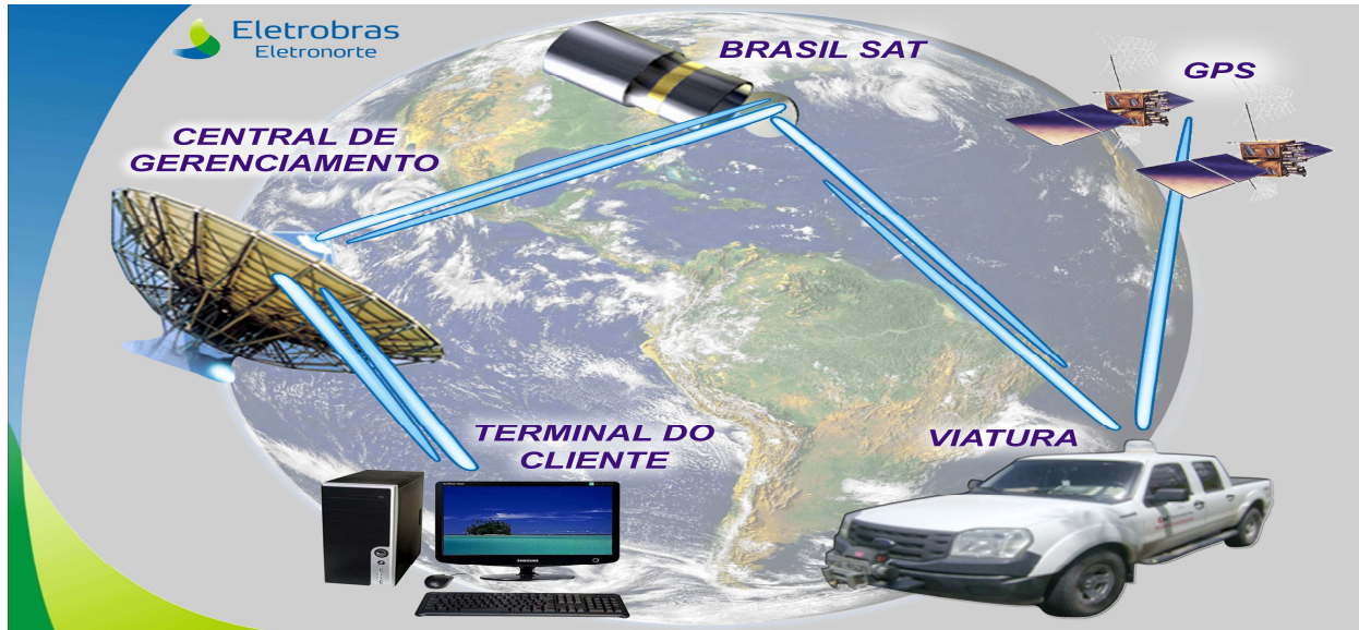
FIGURA 2 – Sistema de comunicação móvel de dados via satélite AUTOTRAC
