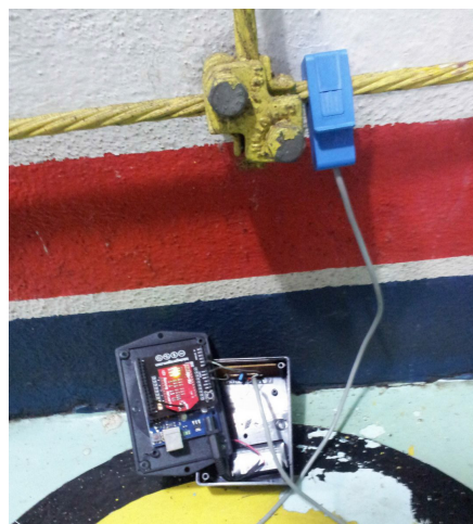
FIGURA 3. Aspecto geral do instrumento de aquisição com o módulo wifi e o sensor de corrente
