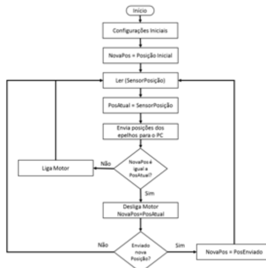
Figura 5. Fluxograma do firmware do sistema microprocessado.
