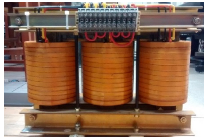
FIGURA 1 – Transformador a seco trifásico usado no estudo.
