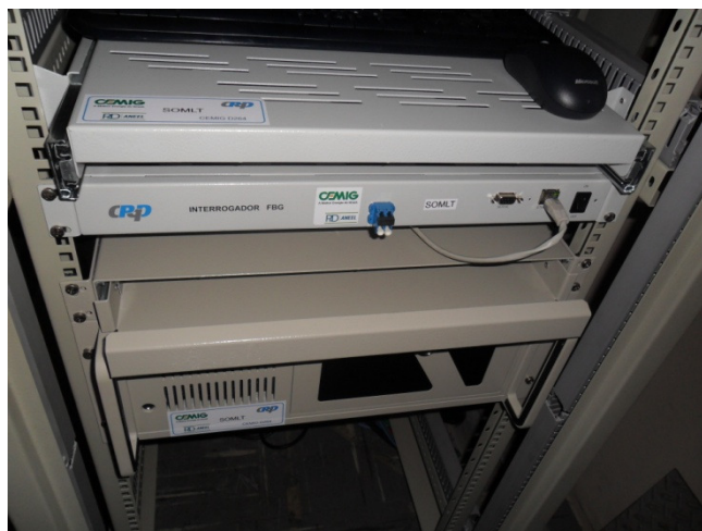
FIGURA 3 - Sistema de interrogação óptica com o gerenciamento das informações em tempo real.
