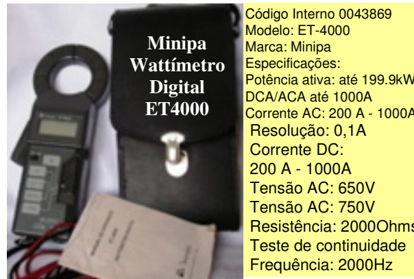
Figura 3 – Instrumentação Utilizada pela Unicamp na Avaliação de Eficiência de Geladeiras
