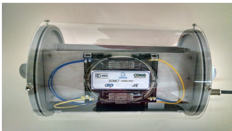
FIGURA 1 - Protótipo da célula de carga óptica SOMLT.
