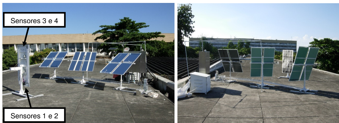
Figura 11. Sistema instalado, pronto para testes e refletindo os raios solares no painel fotovoltaico.
