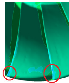
Figura 36 - Distribuição de pressão na borda de saída
