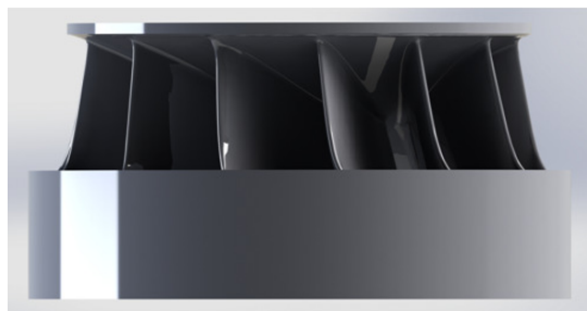
Figura 24 – Modelagem 3D obtida do rotor escaneado – Vista e corte
