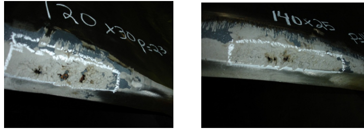
Figura 2 – Erosões anormais na borda de saída das pás
