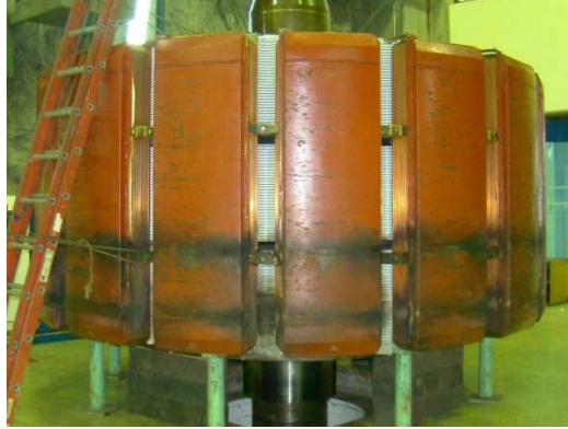
Figura 3 – Rotor do gerador desmontado com marcas devido à falta no gerador
