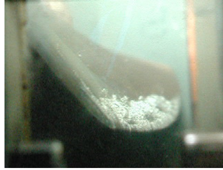
Figura 5 – Cavitação de entrada
