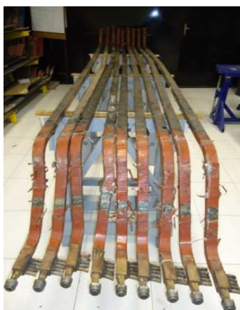
FIGURA 6 – Barras retiradas da UG-10 após 19 anos de Operação
