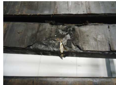
FIGURA 12 – Perfuração por ensaio de tensão aplicada.
