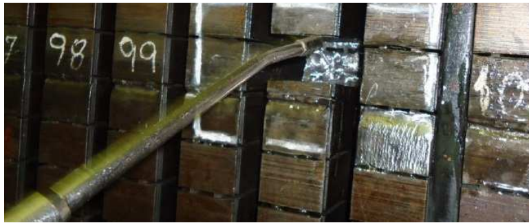
Figura 10 – Aplicação da resina isolante no núcleo do estator
