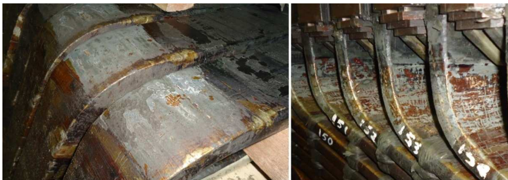
Figura 6 – Barras do estator deterioradas
