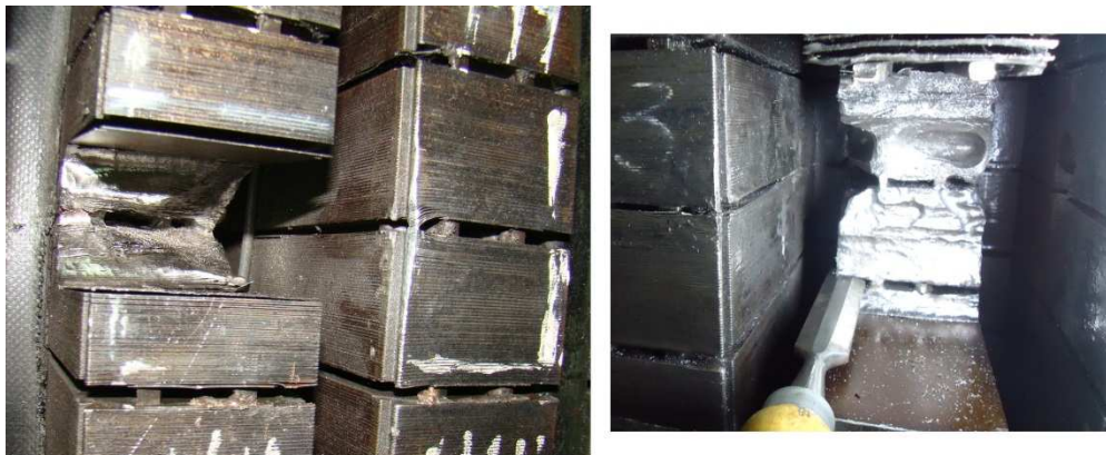
Figura 9 – Detalhe do núcleo do estator – Segmentos dos pacotes de lâminas retirados
