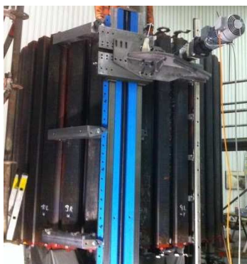
Fig. 16: Usinagem da coroa do rotor no campo.
