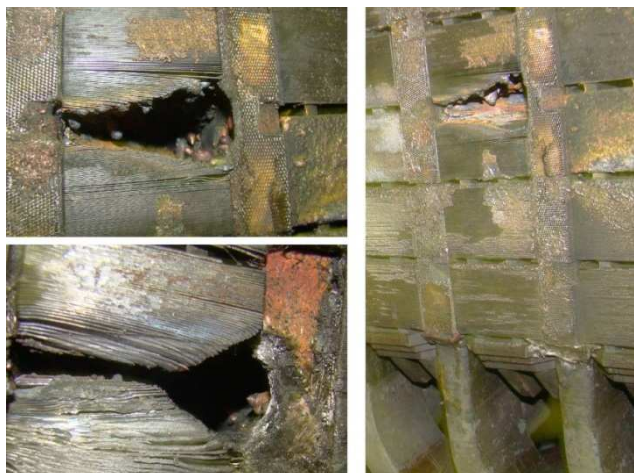
Figura 5 – Núcleo do estator danificado
