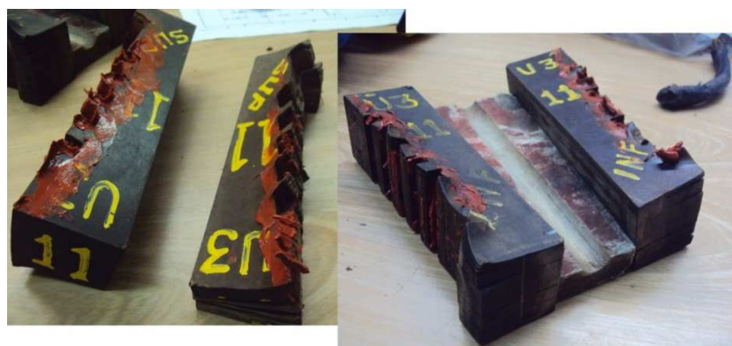
Figura 2 – Cunha interpolar danificada
