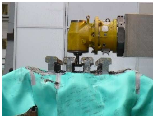
Fig. 17: Exemplo da usinagem de polo em fábrica da Voith Hydro para um projeto típico.
