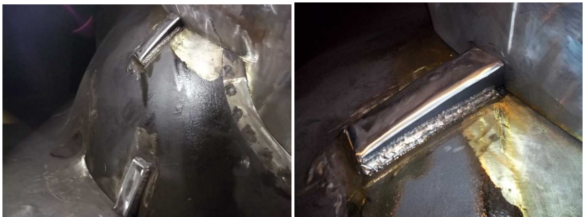
FIGURA 6 – Detalhe das travas soldadas.
