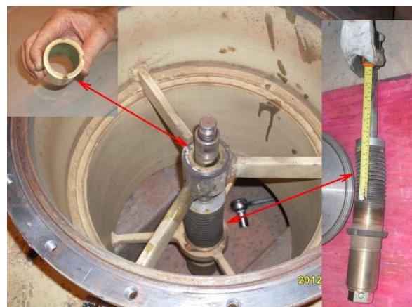
Figura 2 – Válvula aberta – detalhe da bucha desgastada e da mola cansada
