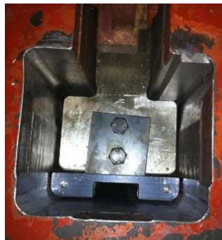
Fig. 16: Ranhura da coroa do rotor e ponta de fixação do polo após remodelação, com chaveta do polo ajustada e calço do entreferro.
