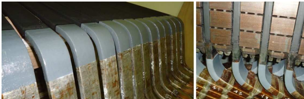
Figura 8 – Barras do estator recuperadas
