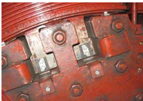
Fig. 15: Geometria original da coroa do rotor e dos polos antes da remodelação pelo lado DE.
