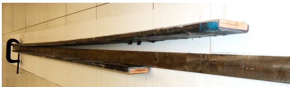
FIGURA 6 – Comparação da curvatura obtida entre uma barra do regime reversível (superior) e outra do regime de base (inferior). A barra do regime de base não apresentou arqueamento após a remoção de parte da isolação, evidenciando a perda da coerência cobre-isolação.
