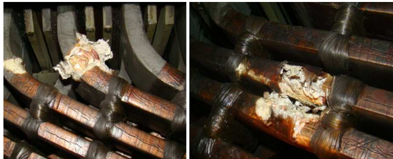
Figura 4 – Barras do estator danificadas na região das cabeças de bobina
