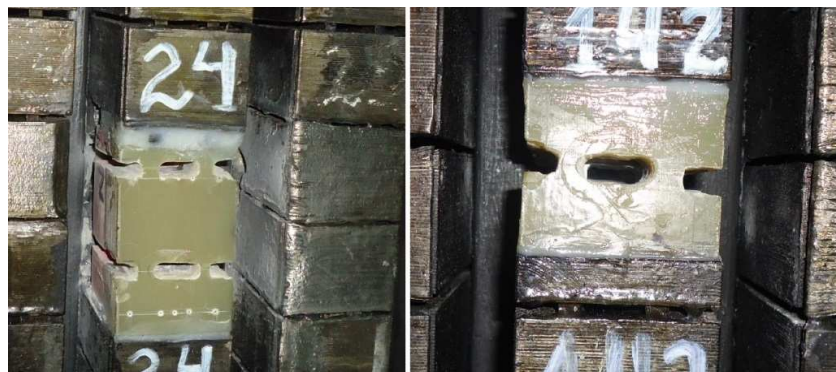
Figura 12 – Segmentos de fibra e resina instalados no local dos segmentos do pacote do núcleo do estator
