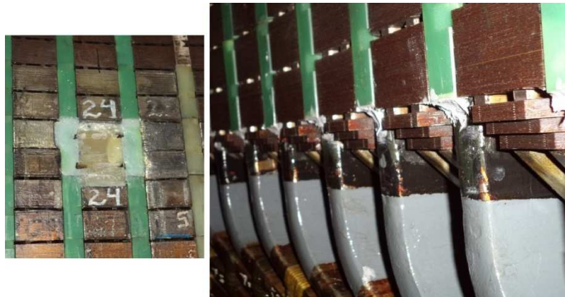
Figura 13 – Detalhes do estator montado
