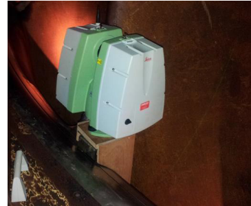
Figura 12 - Posicionamento do escâner sobre a roda
