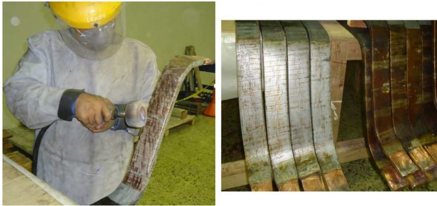
Figura 7 – Preparação das barras do estator retiradas para recuperação
