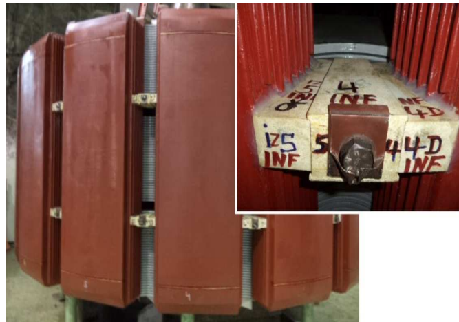
Figura 14 – Rotor do gerador montado com as cunhas interpolares
