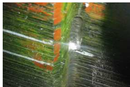
Fig. 14: Escavação típica de trinca na ranhura da coroa do rotor, ao lado da área de contato.
