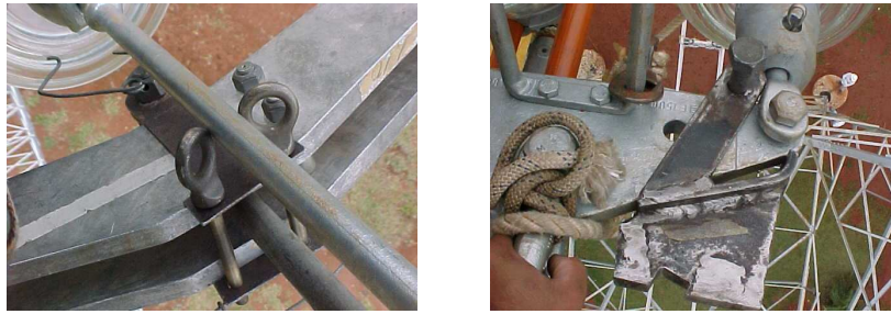
FIGURA 3 – Exemplos típicos de interferência e necessidade de ajuste do ferramental de linha viva
