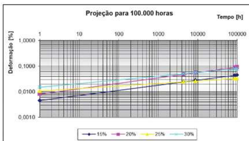
Figura 7 - Extrapolação da fluência para 100 000 h Cabo OPGW com variação de tração método – NBR 7303
