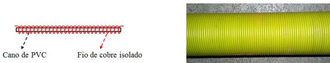
FIGURA 2 – Linha de transmissão infinita artificial constituída de um fio isolado espinado em um tubo de PVC
