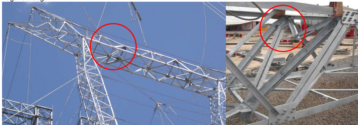
FIGURA 07 – Situação A: Falha com 75% de carga
