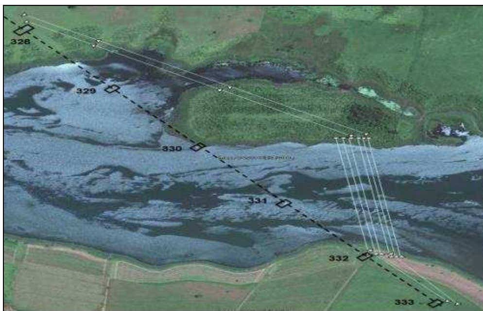
FIGURA 6 – Vista do Traçado da LT e das Variantes Provisórias
