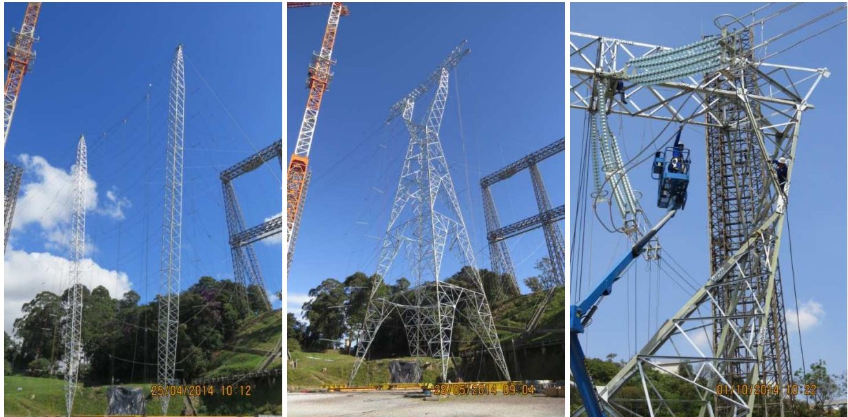
Figura 5 – Ensaio de Cargas das Torres tipos BLCR e BLSP – Ensaio de Montagem Cadeias Torre tipo BLA60
