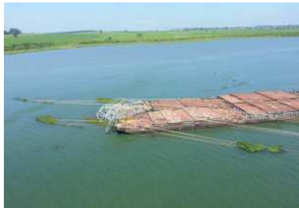
FIGURA 3 – Detalhe da Colisão com Torre 331
