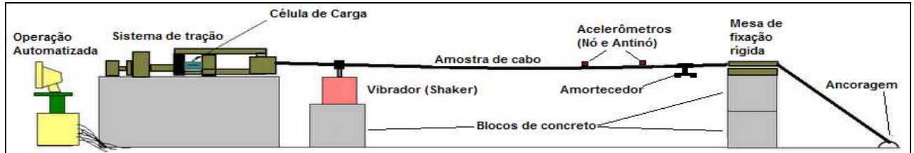
Figura 2: - Esquema da disposição dos elementos componentes do ensaio de eficiência e potência dissipada.
