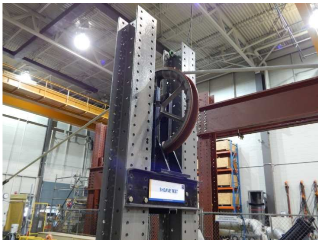
Figura 7. Ilustração da amostra em teste de puxamento por polia.
