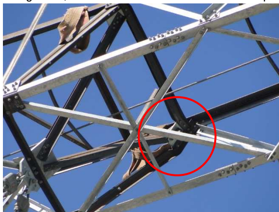
FIGURA 08 – Situação B: Falha com 75% de carga
