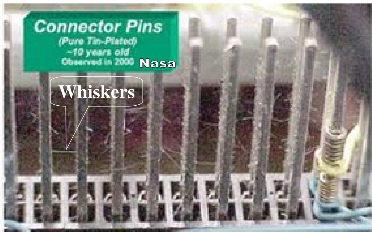
Figura 2 – Whiskers em Terminais Niquelados de Placa Eletrônica [7]
