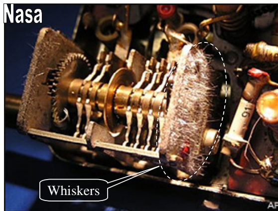
Figura 1 – Capacitor Retirado de Espaçonave com Whiskers [5]
