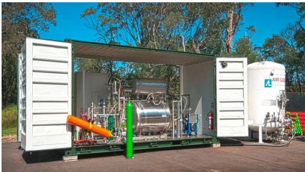
FIGURA 2 – equipamento de reciclagem de gás SF6
