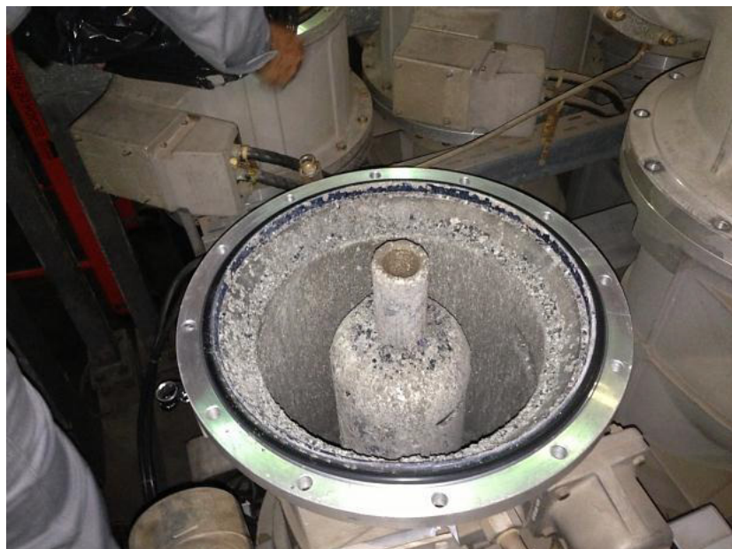
Figura 4 – Tela unifilar manobras. Figura 5 – foto do contato móvel do secc. 36829-352 após ocorrência.
