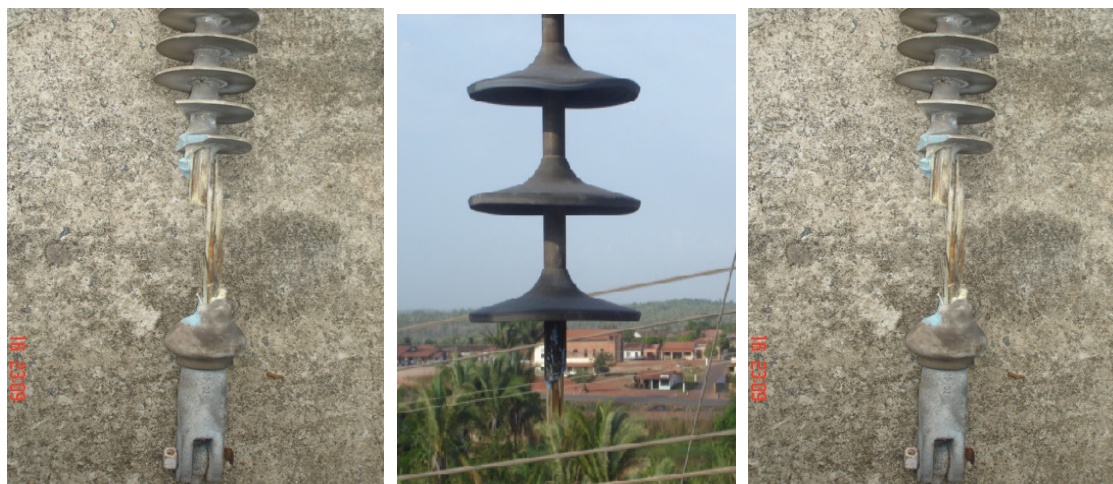
FIGURA 2 – Falhas em isoladores poliméricos da Eletrobras Eletronorte
