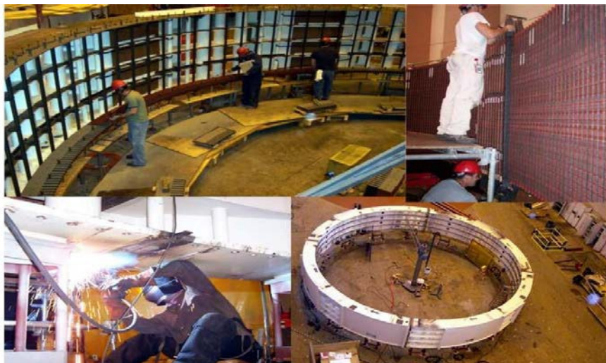
Figura 2: Processo de laminação e tamanho do estator
