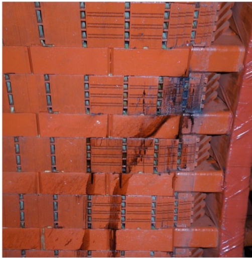
Figura 1-(a) Exemplo de um núcleo de estator queimado.
