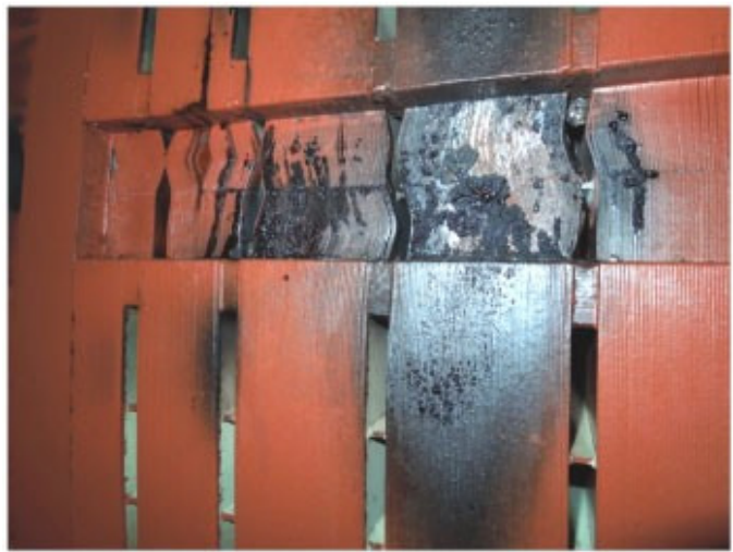
Figura 1-(b) Exemplo de um núcleo de estator queimado.
