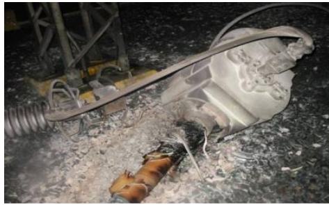
Figura 1 – Explosões de Transformadores de Corrente na CFE
