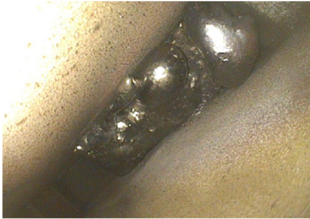
Figura 5: Inspeção de espaço vazio de dutos de resfriamento em zona superaquecida
