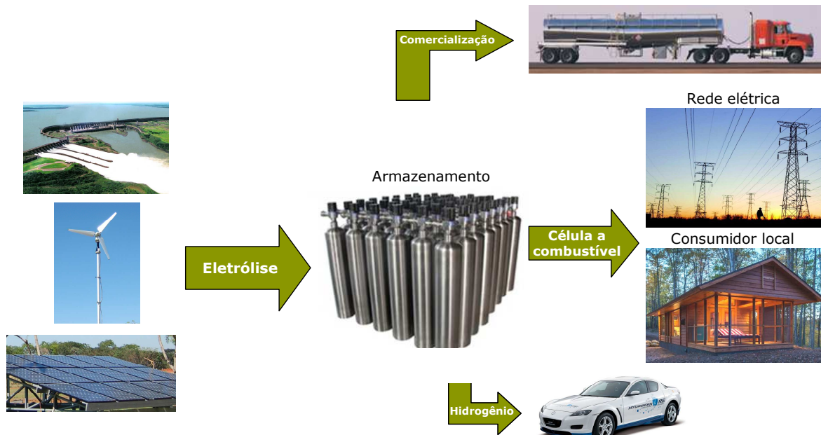
FIGURA 1 – Esquema de conversão, armazenamento e uso final de energia envolvendo o hidrogênio.
