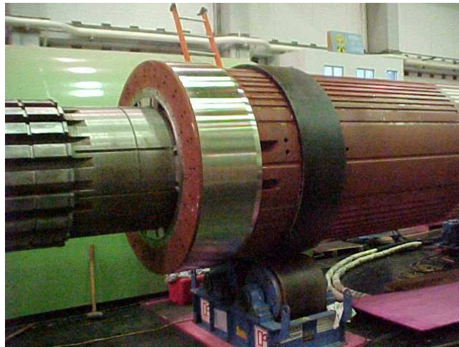
Figura 5. Anel de retenção do lado da turbina
