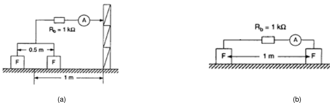
FIGURA 5 – Determinação das tensões de (a) toque; e (b) passo.
