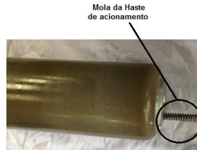
FIGURA 8– Detalhe da mola do isolador da haste de acionamento
