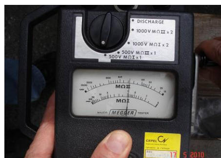
Leitura da resistência superficial = 1 MΩ
