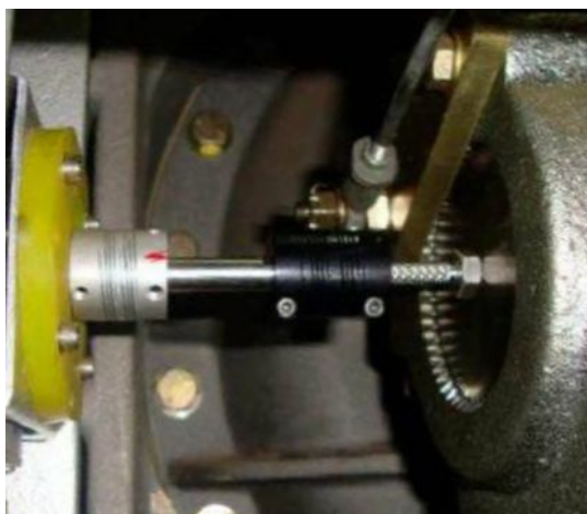
FIGURA 3 – Adaptação da instalação do encoder
