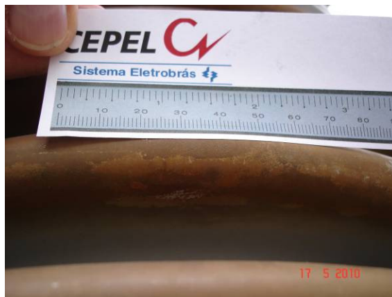
Ferrugem na parte inferior da saia de porcelana
