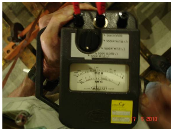
Leitura da resistência superficial = 2 MΩ
