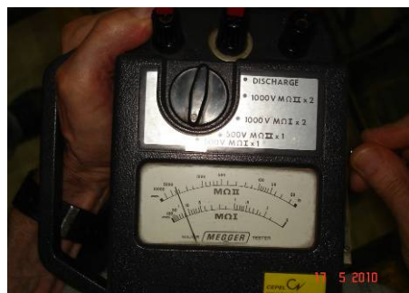
Leitura da resistência superficial = 15 MΩ
