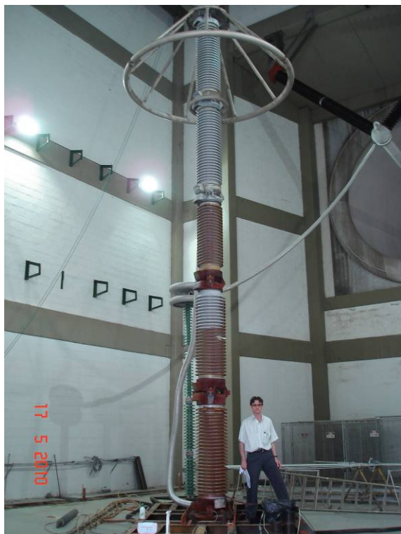
Para-raios montado em cinco módulos
