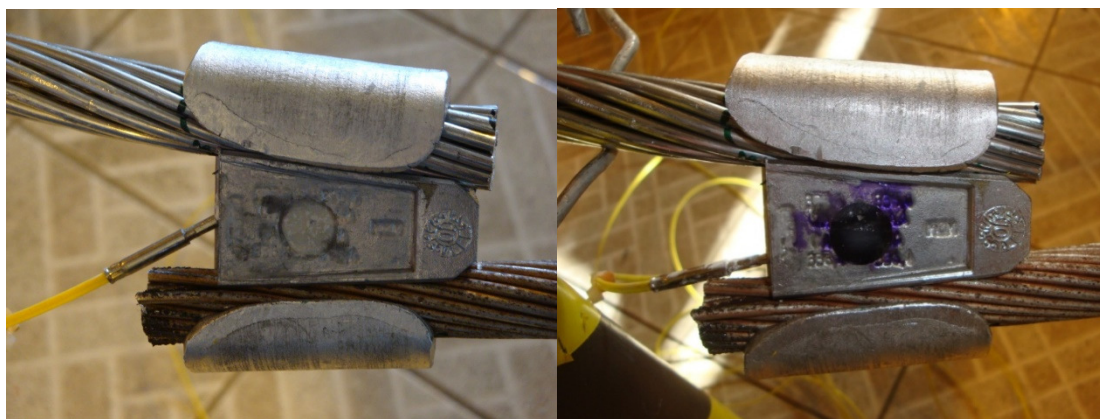
FIGURA 7 – Protótipo de sensor termosensível: antes e após ativação (cores branca e roxa, respectivamente).
