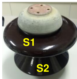
Figura 2 – IPTL utilizado nos ensaios de emissão acústica.
