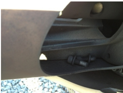
Figura 3 – Parafusos de fixação do suporte do contato fixo soltos.
