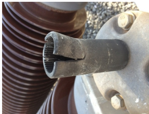
Figura 4 – Mangote de acoplamento do eixo de acionamento do contato auxiliar, da câmara RA1 quebrado.
