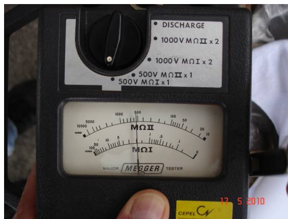
Leitura da resistência superficial = 2 MΩ
