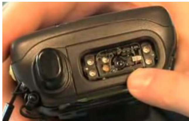
Figura 6 – Coletor de dados do EDA, laser para ler os códigos de barras.
