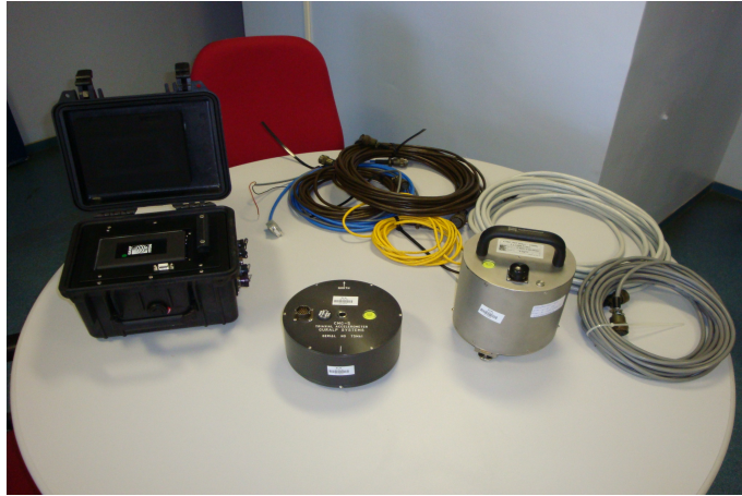
FIGURA 4 – Conjunto da Estação: sismógrafo, acelerômetro e sismômetro.
