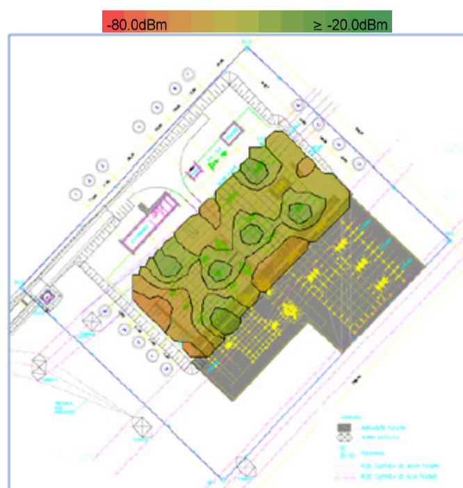
FIGURA 2 – Nível de potência de sinal em uma subestação típica
