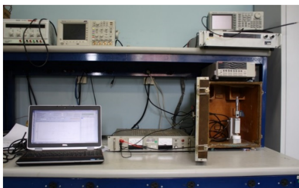
FIGURA 1 - Arranjo experimental para medidas de corrente de polarização.
