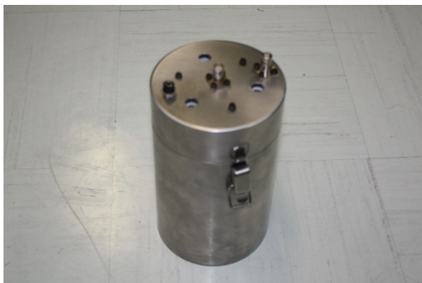
FIGURA 6 - Célula de medida de dielétricos líquidos.
