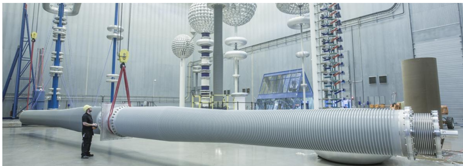
Figura 2 – En 2012, ABB realizó ensayos tipo al primer buje de 1100 kV DC en el mundo.
