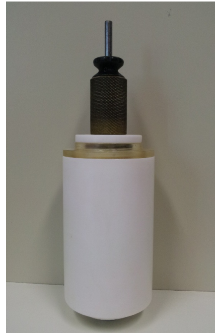
FIGURA 7 – CÉLULA DE ENSAIO UTILIZADA NOS ENSAIOS DE RIGIDEZ DIELÉTRICA SOB IMPULSO ATMOSFÉRICO
