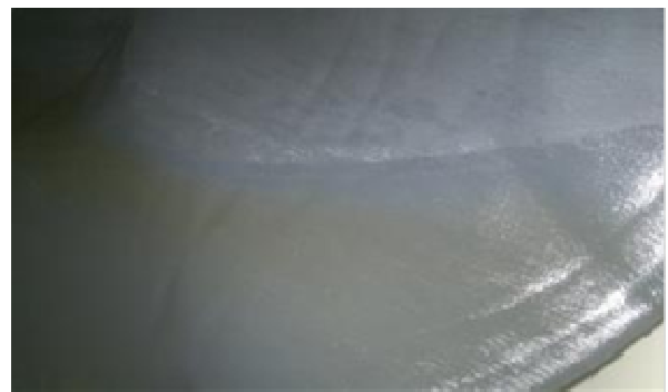
FIGURA 13 – Lado externo da bolsa de borracha, onde pode ser identificada uma linha de separação entre o nível de óleo e o ar.
