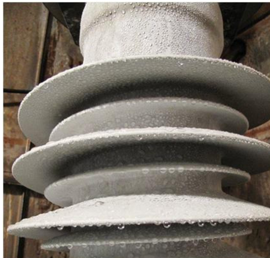
Figura 9 – Aislador después de una prueba de 5.000 horas de esfuerzo múltiple.
