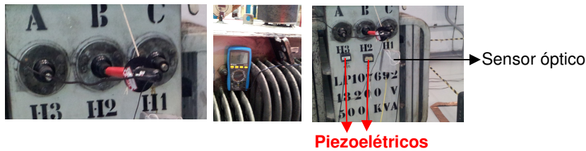
FIGURA 4 – Detalhe do divisor de tensão, medidor e sensores.
