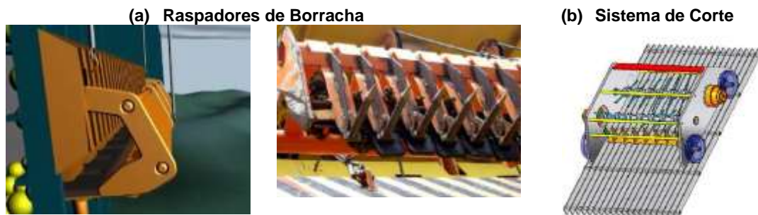
Figura 3 – Dispositivos Existentes para a Remoção de Mexilhões Dourados
