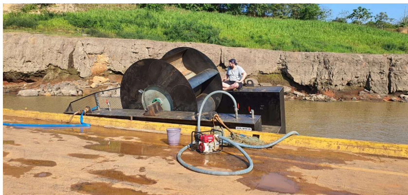
Figura 7: Adernação do equipamento quando na colocação do lastro de água
