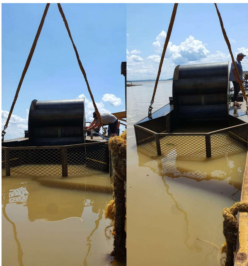
Figura 6: equipamento sendo colocado na água (operação de lastreamento)
