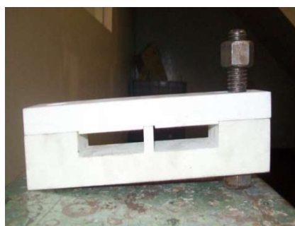
FIGURA 10: Novo calço de fixação da barra DC
