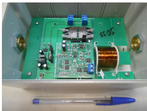
Figura 3 – a) Unidade de Monitoramento protótipo. b) Unidade de Monitoração cabeça de série.
