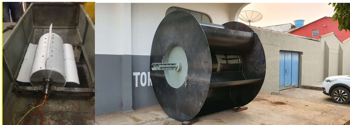
Figura 3: rotor da turbina Michele-Banki com máquina elétrica em seu interior
