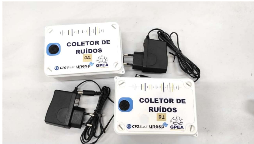
Figura 4 – Coletor de ruídos desenvolvido na UNESP Ilha Solteira.
