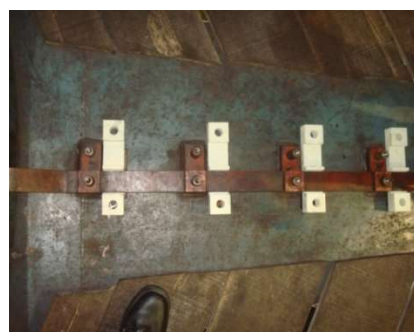
FIGURA 11: Ensaio de posicionamento dos novos calços de fixação da barra DC
