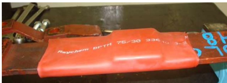
FIGURA 7: Ensaio de instalação do termocontrátil
