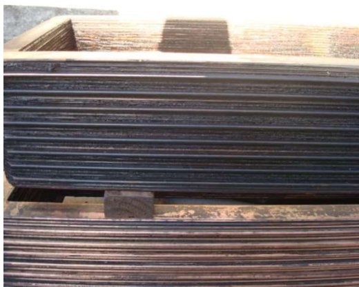
FIGURA 3: Sujeira impregnada nas bobinas polares.
