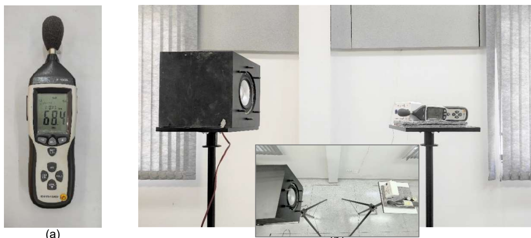
Figura 6 – (a) Sonômetro Impac® IP-900DL. (b) Processo de calibração do Coletor de Ruídos.
