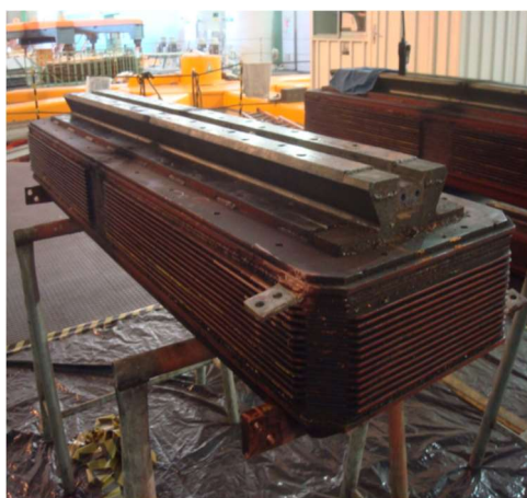
FIGURA 1: Pólos com acúmulo de sujeira proveniente de pó de escova e óleo
