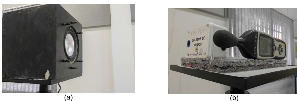
Figura 7 – (a) detalhe da caixa de som utilizada no processo de calibração. (b) detalhe do posicionamento do Coletor e do Sonômetro durante o ensaio.
