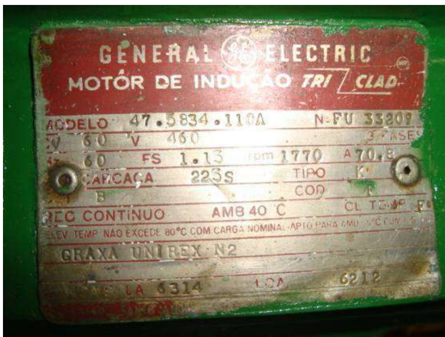
Figura 2 – Placa do Motor padrão 60 cv.
