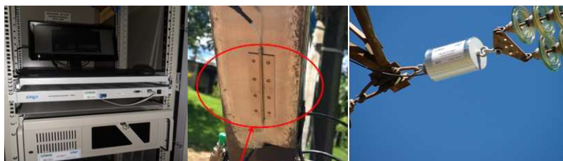
FIGURA 7 - Interrogador de sensores Grade Bragg aplicados em uma linha real de 138 kV da Cemig.
