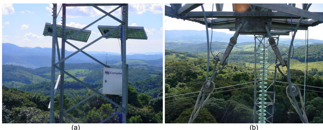
FIGURA 11 - (a) Sistema de aquisição dos dados e painéis de energia solar e (b) Posição da instalação das células de cargas elétricas nos estais na LT.
