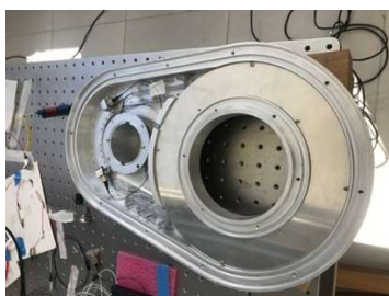
Figura 3 – Estrutura que acomoda conjuntamente os sensores de medição de corrente.
