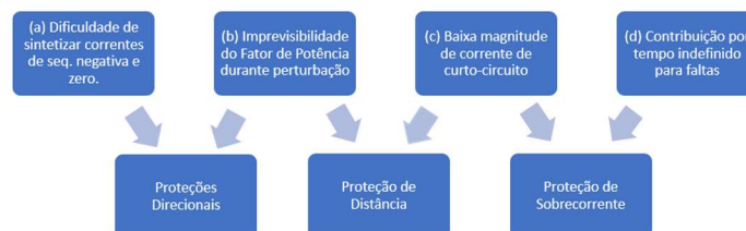
FIGURA 9 – Características dinâmicas da IBR e os impactos às proteções associadas.
