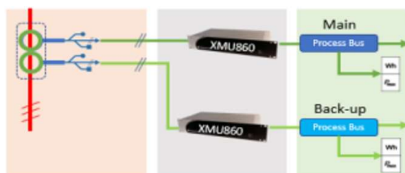
Figura 4: LPIT - Esquema Redundante dual sensor
