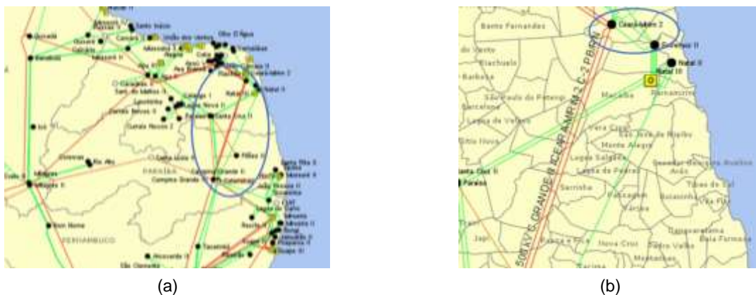
Figura 6 - Diagrama do SIN com destaque no circuito duplo da LT Campina Grande III – Ceará Mirim 2 500 kV e no circuito duplo da LT Ceará Mirim 2 – Extremoz 230 kV, respectivamente, disponibilizado no site do ONS.
