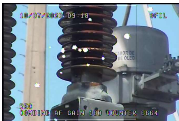
FIGURA 8a -Imagem UV Isolador 1 Fase V Chave 1
