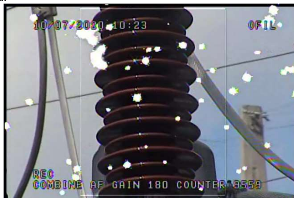
FIGURA 9b-Imagem UV Isolador 1 Fase V Chave 2
