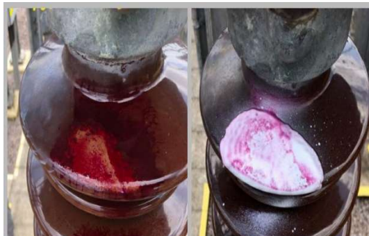
FIGURA 10 – Ensaio de líquido penetrante na parte do isolador que sofreu danos
