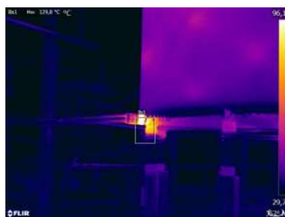
Figura 10. Conector Chapa-chapa. NCT no SVC de ETD. NCT com mais de 130 graus.
