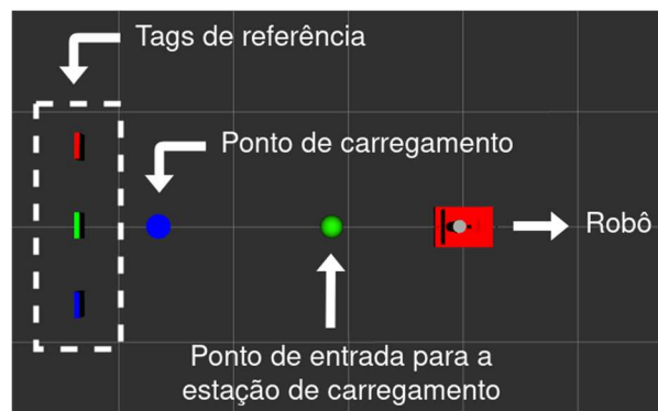
Figura 8 - Orientação do robô a partir das tags de referência durante o estacionamento autônomo.
