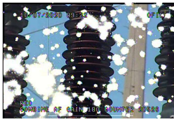
FIGURA 8b- Imagem UV Isolador 2 Fase V da Chave 1
