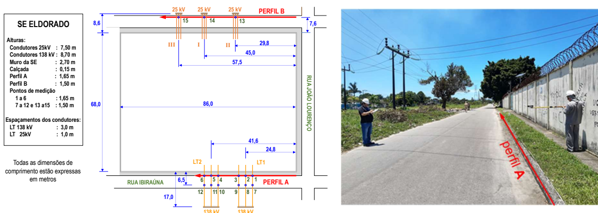
Figura 8. Medição do perfil paralelo ao muro da subestação
