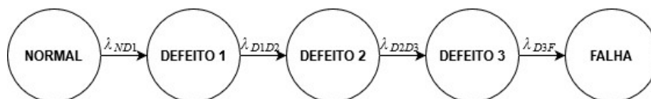
Figura 2 – Exemplo de Diagrama de Markov com 3 estados de Defeito
