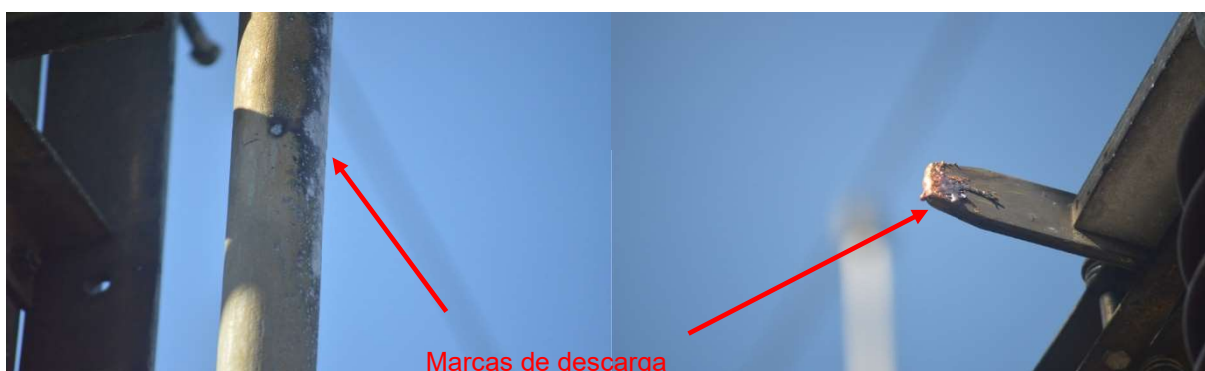
FIGURA 2 - Evidências de descarga elétrica entre a chave seccionadora de 69 kV e o pórtico adjacente
