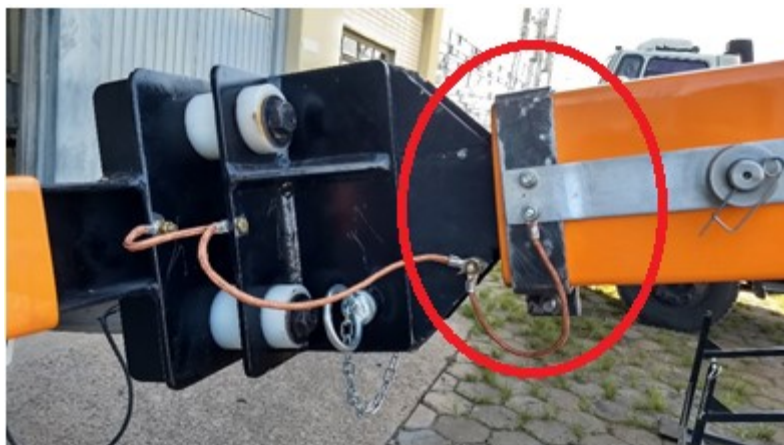
FIGURA 6 – Reforço estrutural na lança isolante
