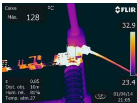
Figura 04. Conector de chave de 69 com NCT de 128 graus.
