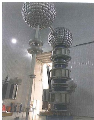
Fonte de tensão aplicada 1200kV com divisor AC
