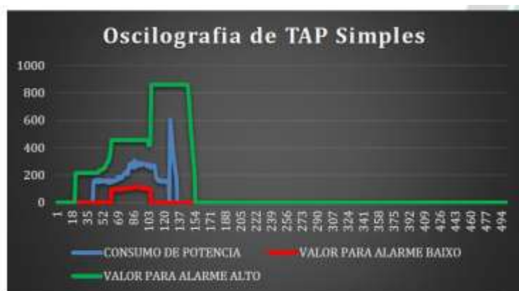
Figura 8 – Oscilografia de uma comutação de tap
