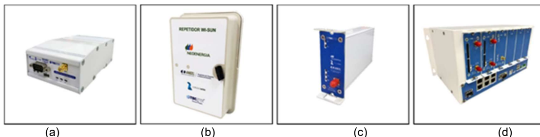
FIGURA 1 - Equipamentos desenvolvidos no projeto: (a) Módulo de Comunicação Wi-SUN, (b) Repetidor Wi-SUN, (c) Concentrador Wi-SUN e (d) Concentrador Multilink.
