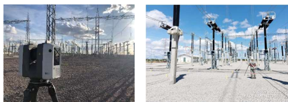
FIGURAS 9 e 10 – Coleta da nuvem de pontos - SE Juazeiro da Bahia III (JZT) - Odoyá.
