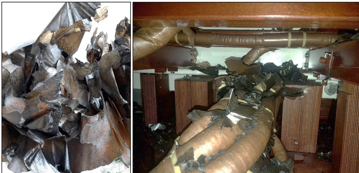
Figura 04 - À direita papel encontrado fora da bucha. À esquerda papel dentro do transformador após inspeção interna.
