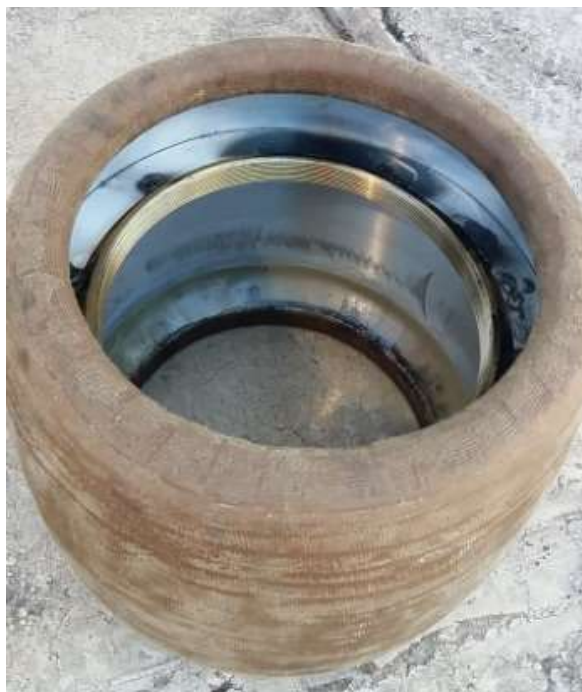
Figura 16 - shield anti corona com marcas de carbonização
