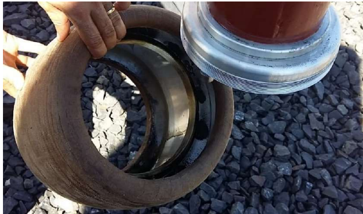
Figura 14 - shield anti corona com marcas de carbonização
