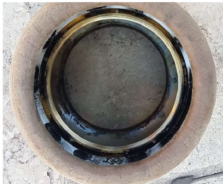
Figura 15 - shield anti corona com marcas de carbonização
