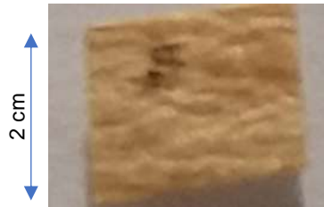
Figura 2 - Amostra de papel coletada de equipamento de geometria coaxial
