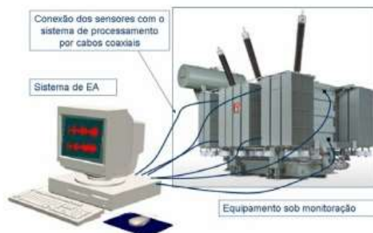
Figura 6 - sistema de medição de EA
