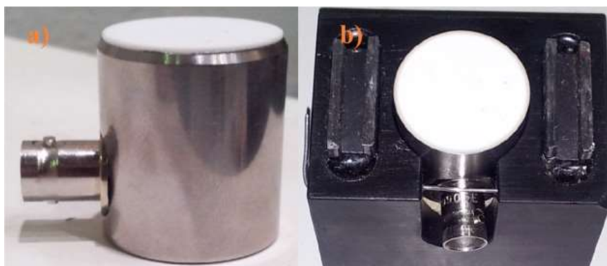
Figura 7 - (a) sensor acústico, (b) base de fixação do sensor
