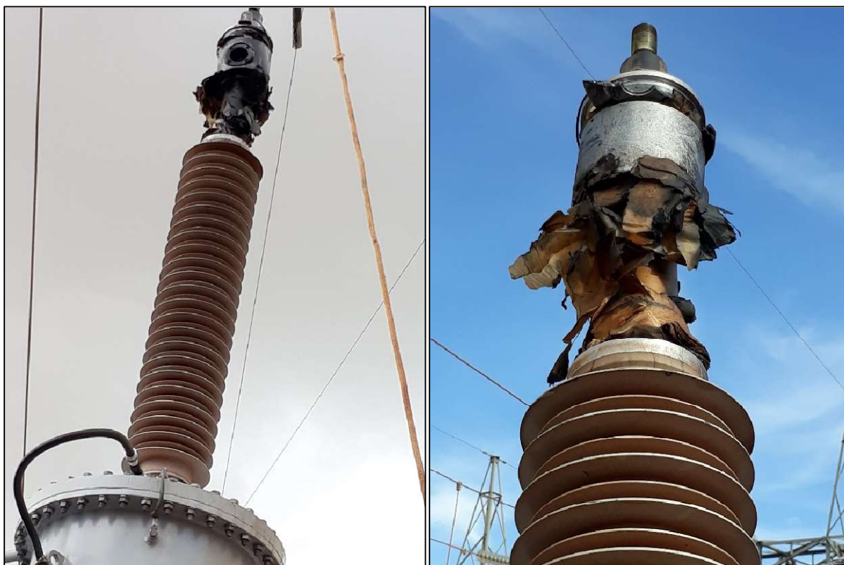
Figura 03 - Bucha após explosão, detalhe do papel saindo da bucha.
